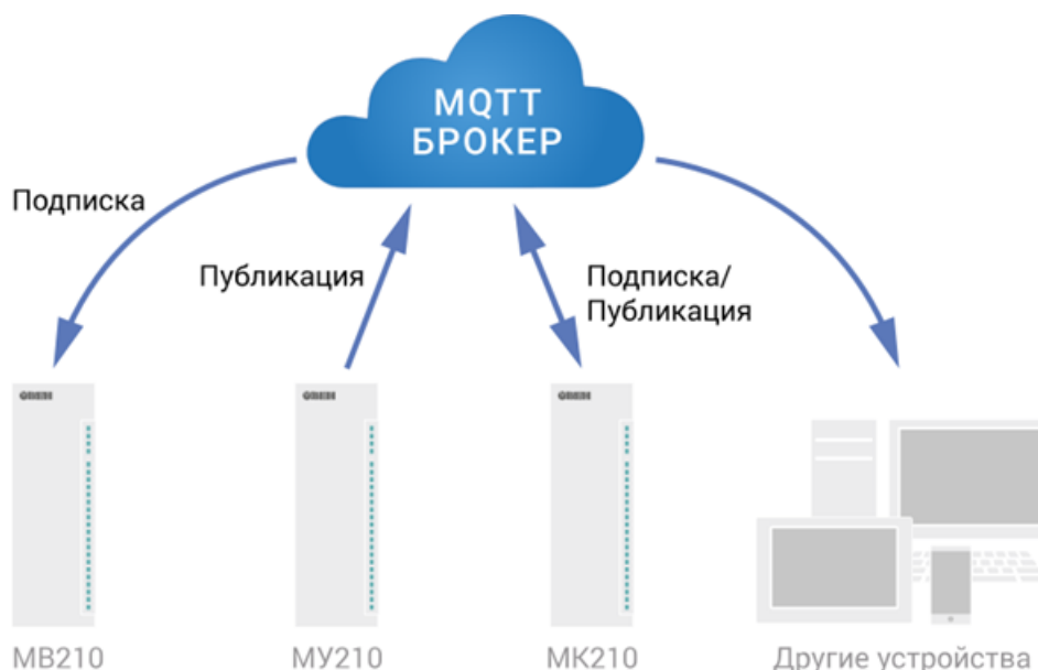
Рисунок 6.2 – Структурная схема обмена по протоколу MQTT
