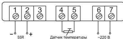
SSR – управление твердотельным реле
