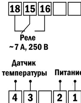
Рис. 5 – Схема подключения
