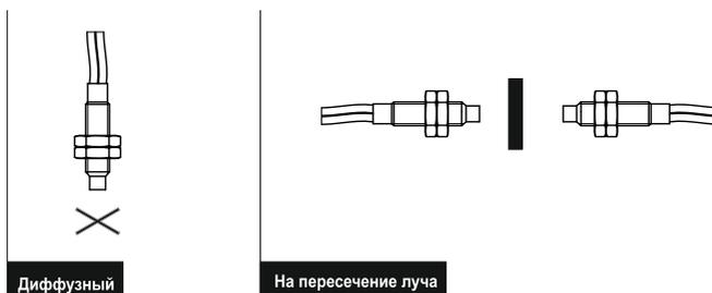
Рисунок 30 - Условия проведения калибровки на максимальную чувствительность для датчиков различного типа
