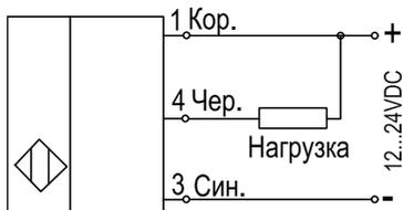
Рисунок 5 – Схема подключения усилителей с NPN – выходом
