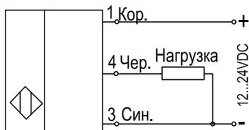
Рисунок 6 – Схема подключения усилителей с PNP – выходом
