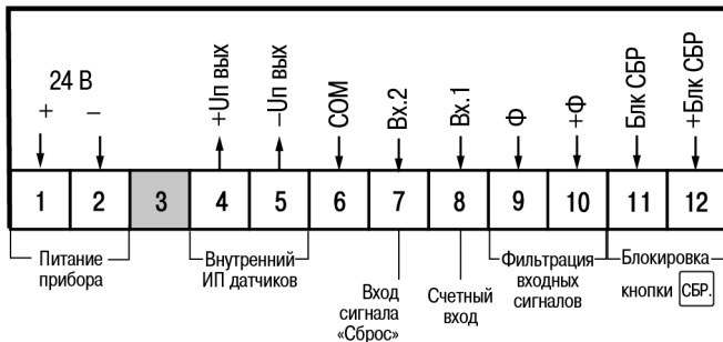
Рисунок 5.1 – Назначение контактов клеммника
