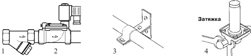
1. Перед монтажом клапана трубопроводы должны быть прочищены, т.к. попадание в клапан инородных частиц может привести к выходу его из строя. Перед входным
