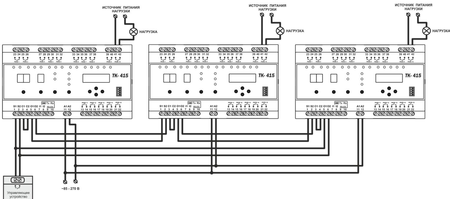
**Рисунок 2.3 - Циклическая работа таймеров в каскадном включении**
