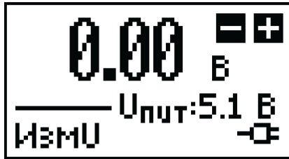
Рисунок 6.2 – Экран прибора в режиме измерения напряжения
