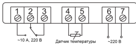
Рис. 2 – Схема подключения. Реле ~10 А, 250 В
