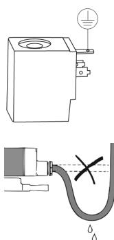
**Внимание!** Вода не должна проникать в клеммную коробку. Кабель необходимо монтировать с образованием петли для стекания капель жидкости.
