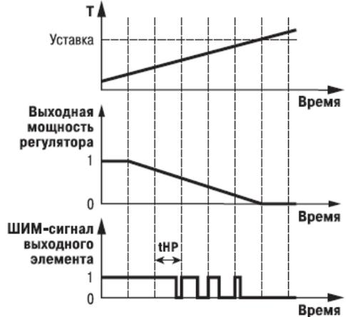
Рисунок 3.5 - Принцип формирования ШИМ-сигнала для «нагревателя»
