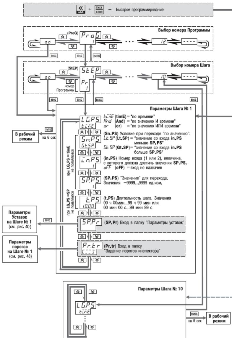
Рисунок 11.7 - Схема задания параметров программ технолога в режиме Быстрого программирования
