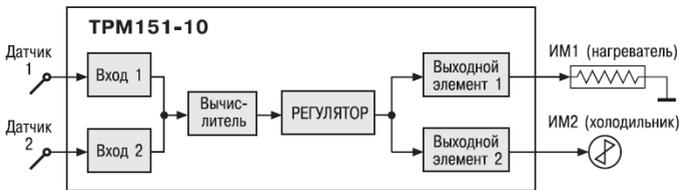
**TPM 151-10.** Одноканальное пошаговое регулирование с помощью системы «нагреватель - холодильник» по измеренной или вычисленной величине.
