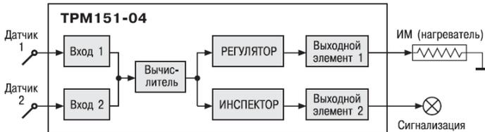
**TPM 151-04.** Одноканальное пошаговое регулирование по измеренной или вычисленной величине. Имеется блок контроля нахождения величины в допустимых границах (Инспектор). Сигнал от Инспектора подается на Выходной элемент 2, к которому подключается средство аварийной сигнализации (лампа, звонок и т. д.).
