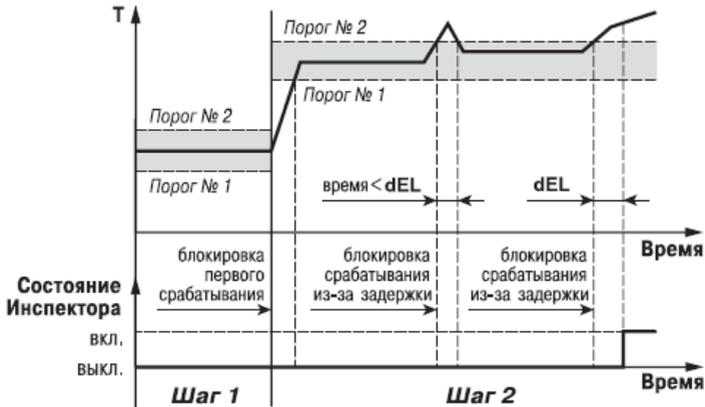
Рисунок 3.7 - Пример логики работы и блокировок срабатывания Инспектора
