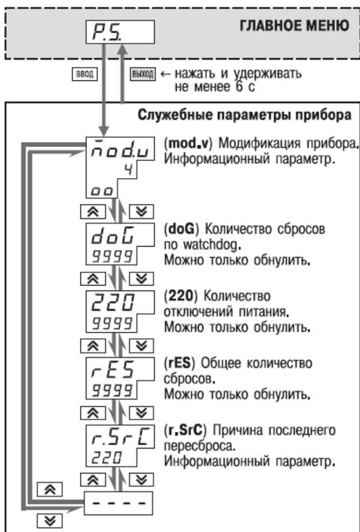
Рисунок 11.21 - Схема доступа к служебным параметрам прибора
