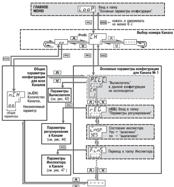
Рисунок 11.9 - Схема задания основных параметров конфигурации
