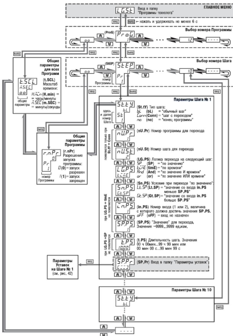
Рисунок 11.17 - Схема задания параметров Программ технолога и Уставок
