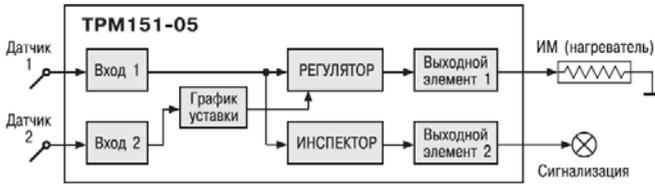
**ТРМ 151-05.** Одноканальное пошаговое регулирование, при этом Уставка Регулятора может быть скорректирована по определенной функции от значения, измеренного на Входе 2. Имеется блок Инспектора, соединенный с ВЭ2.
