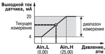
Рисунок 3.4 - Пример задания диапазона измерения активного датчика
