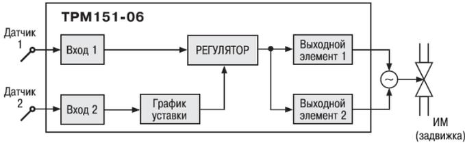
**ТРМ151-06.** Одноканальное пошаговое регулирование задвижкой без датчика положения. При этом Уставка Регулятора может быть скорректирована по определенной функции, измеренного на Входе 2.
