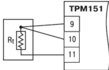
Рисунок Г.1 - Подключение ТС по трехпроводной схеме
