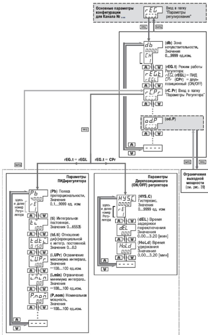
Рисунок 11.12 - Схема задания основных параметров конфигурации (продолжение).
