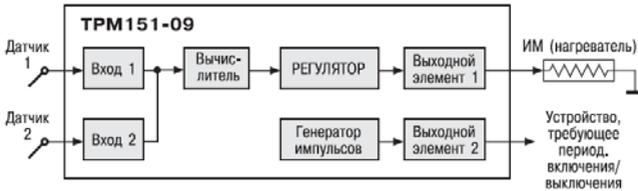
**TPM 151-09.** Одноканальное пошаговое регулирование по измеренной или вычисленной величине. На второй выход прибора можно на определенном шаге программы подать периодические импульсы для включения дополнительного оборудования или сигнализации о ходе технологического процесса.
