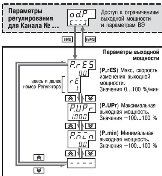
Рисунок 11.14 - Схема задания основных параметров конфигурации (продолжение).
