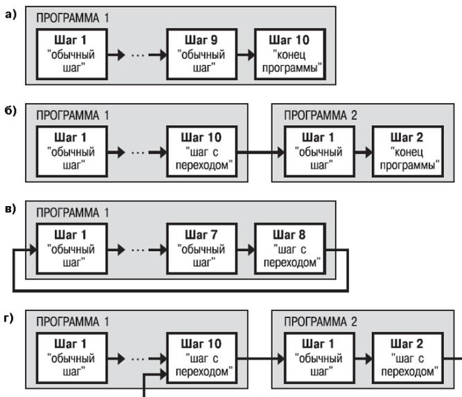
**Рисунок 3.3 – Примеры Программ, которые можно реализовать с помощью различных типов Шагов: программа из 9 Шагов и «конца программы» (а); из 11 Шагов и «конца программы» (б); из 8 Шагов, работающая по бесконечному циклу (в); из 12 Шагов (последние 3 Шага повторяются по бесконечному циклу) (г)**
