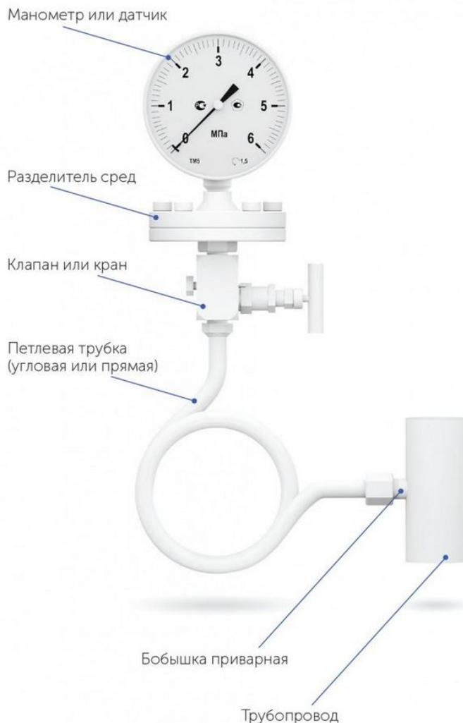
Типовой узел отбора для подключения вакуумметра состоит из приварной бобышки с площадкой под уплотнительную прокладку, петлевой трубы, трехходового крана или игольчатого клапана. В качестве уплотнения в резьбовых соединениях между приварной бобышкой, краном и вакуумметром рекомендуется применять паронитовую, фторопластовую или медную прокладку.
