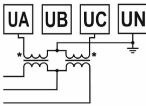
Рис. 7 – Подключение трансформатора напряжения  $x/380$  В (трехфазная цепь без нейтрали)
