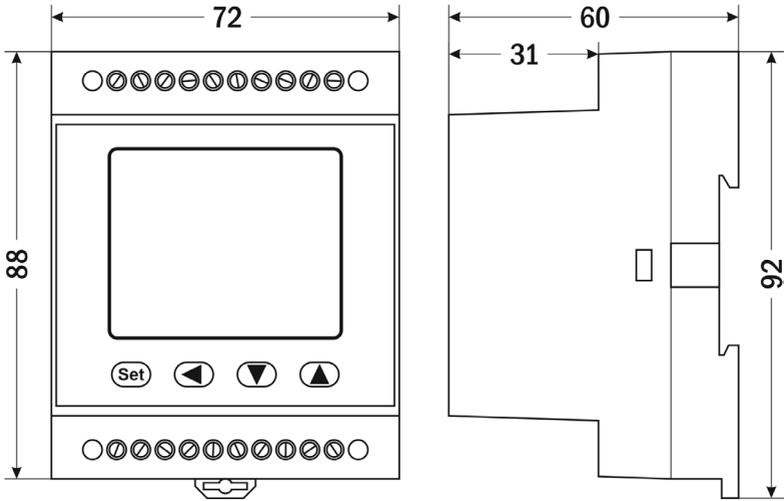
*Рис. 2 – Размеры прибора*
