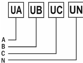
*Рис. 4 – Подключение напряжения напрямую до 380 В (трехфазная цепь с нейтралью)*
