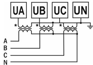
*Рис. 5 – Подключение трансформатора напряжения  $\times/380 \text{ В}$  (трехфазная цепь с нейтралью)*
