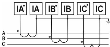
Рис. 9 – Подключение трансформатора тока  $x/5$  А
