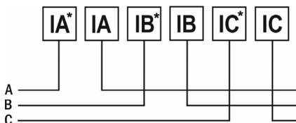
Рис. 8 – Подключение тока напрямую до 5 А
