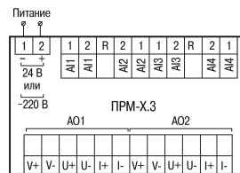
Рисунок 3 – Назначение контактов клеммника
