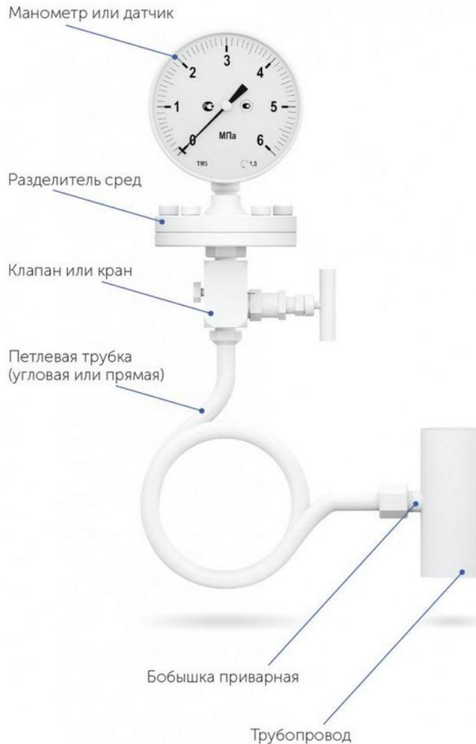
Типовой узел отбора для подключения манометра состоит из приварной бобышки с площадкой под уплотнительную прокладку, петлевой трубки и игольчатого клапана. В качестве уплотнения в резьбовых соединениях между приварной бобышкой, краном и манометром рекомендуется применять паронитовую, фторопластовую или медную прокладку.
