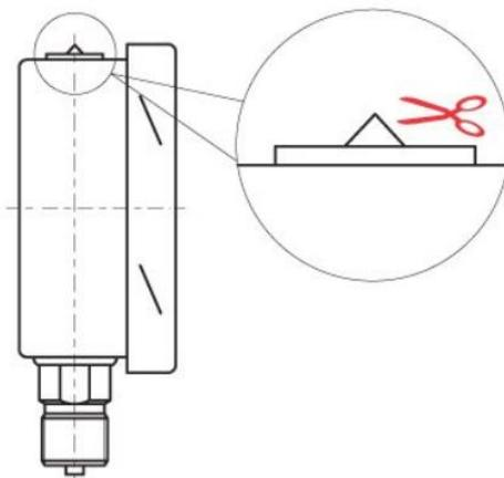
Для манометра с гидрозаполнением
