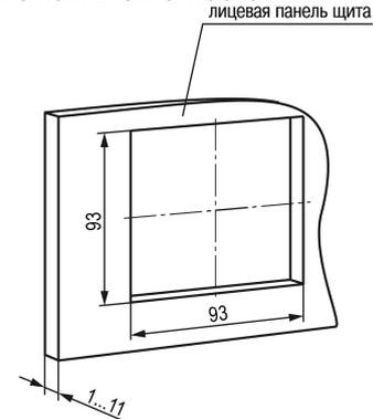
Рисунок 3 – Монтажный вырез под прибор в корпусе Щ2
