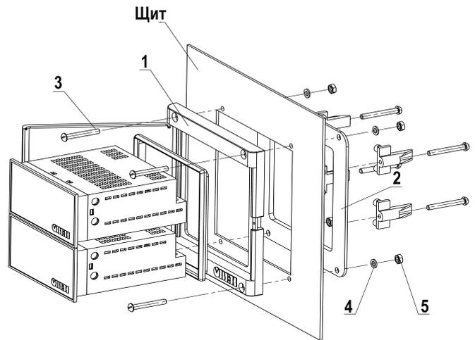
Рисунок 2 – Монтаж в щит двух приборов в корпусах Щ2
