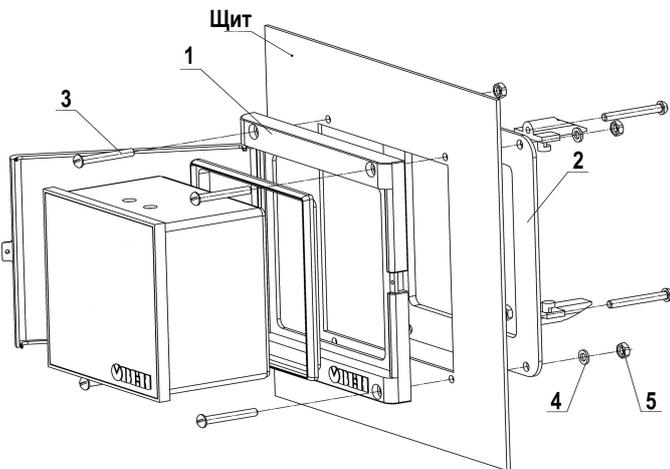
Рисунок 1 – Монтаж в щит прибора в корпусе Щ1
