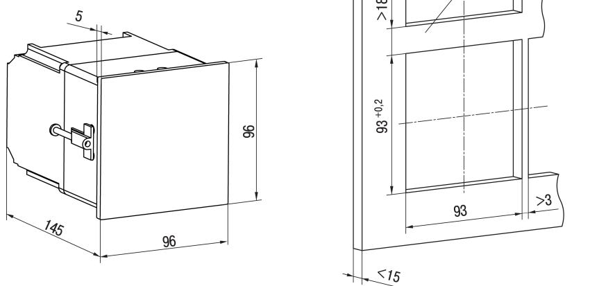
**Рисунок 4.2 – Габаритные размеры корпуса Щ4**
