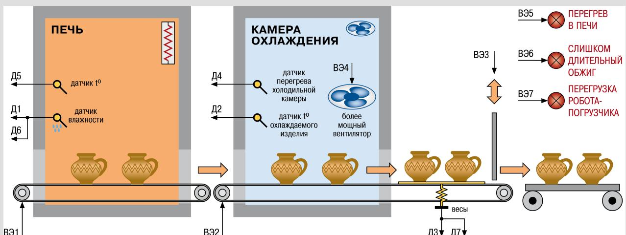
Рисунок 7.4 – Использование восьмиканального регулятора TPM148 второй модификации в автоматизированном процессе обжига глиняных изделий
