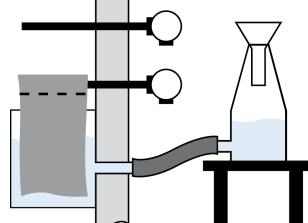
**Рисунок Б.4 – Конструкция резервуара для воды, не требующая входа в камеру**
