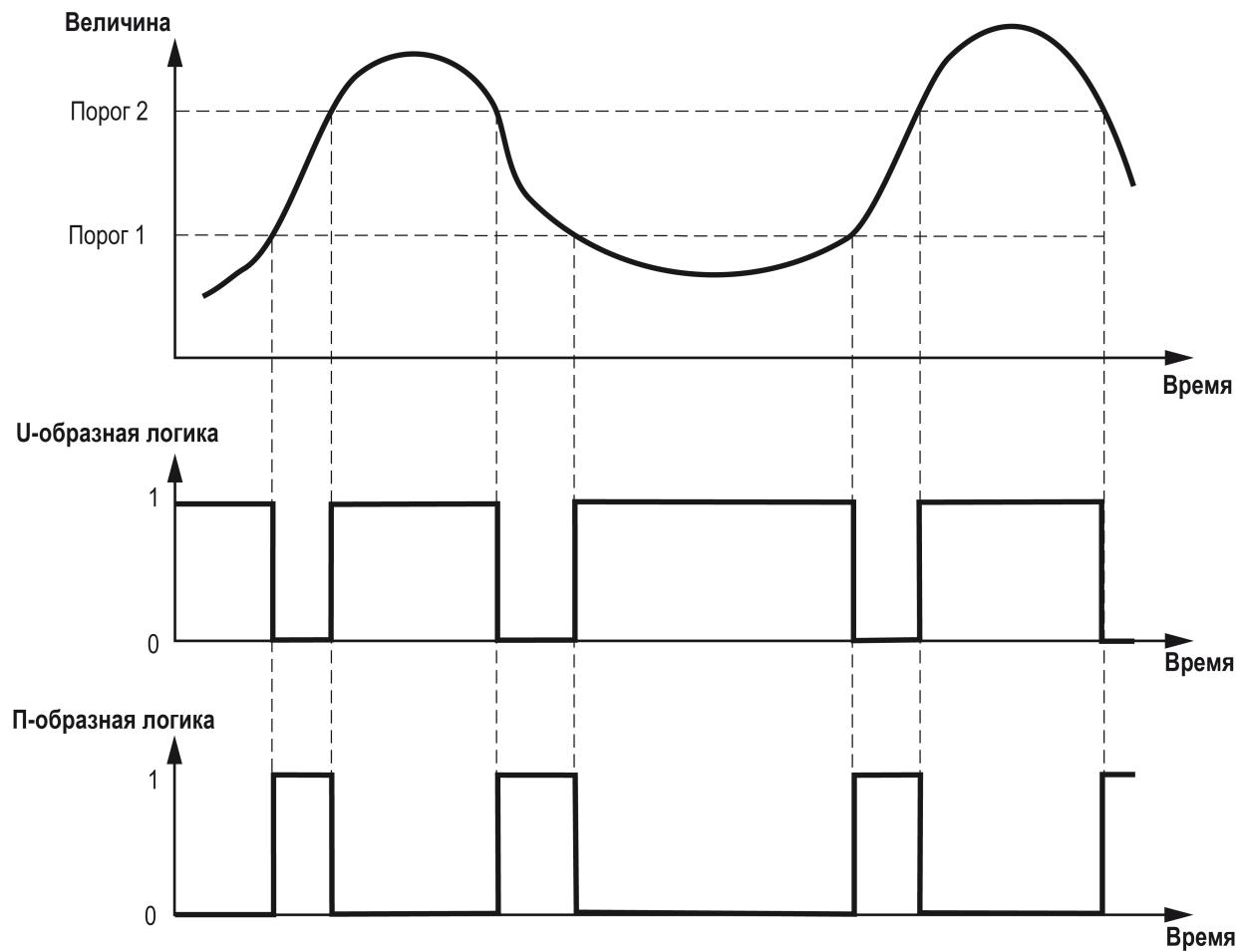
Рисунок 10.53 – Работа Инспектора по U-образной и П-логикам
