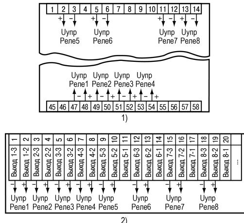
Рисунок 5.20 – Схема подключения твердотельных реле прибора: 1) в корпусе Щ4, 2) в корпусе Щ7
