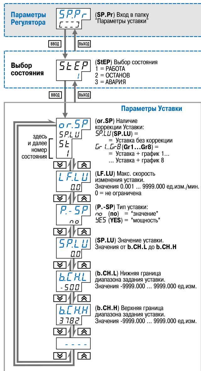
Рисунок 8.21 – Схема задания параметров Уставки
