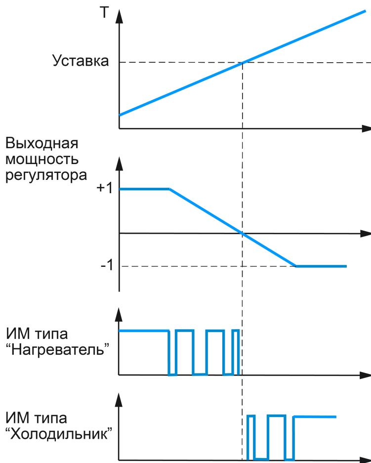
**Рисунок 10.16 – Принцип формирования ШИМ-сигнала для системы «нагреватель–холодильник»**
