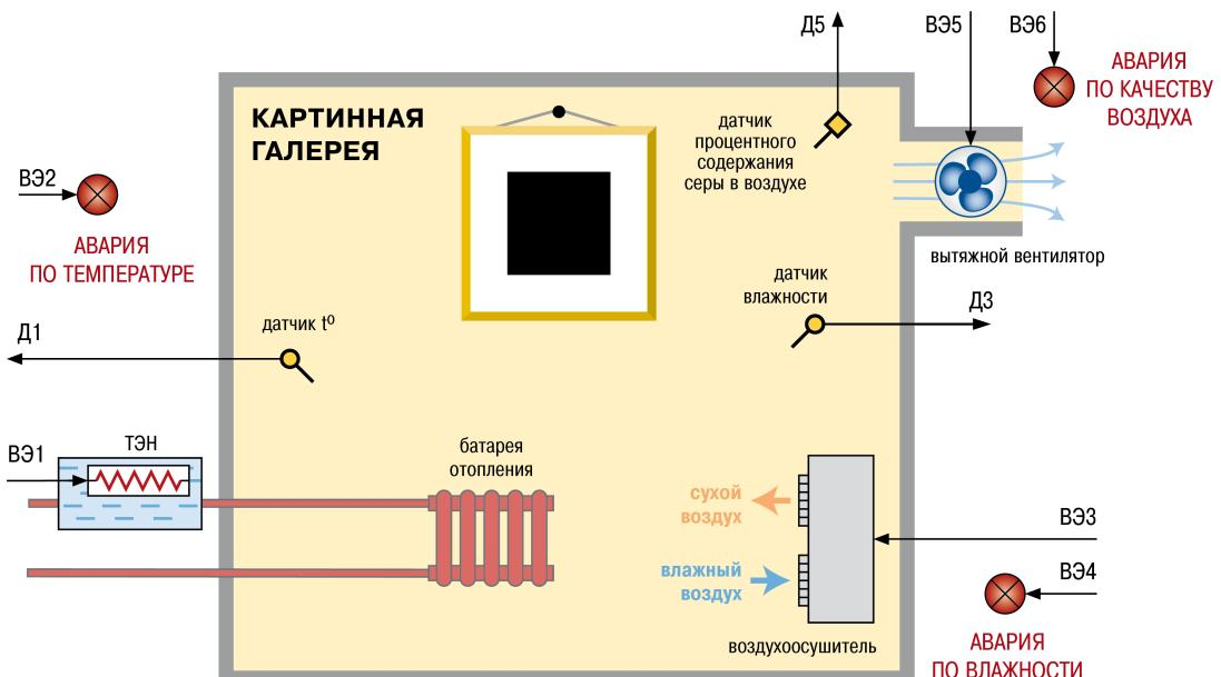
Рисунок 7.10 – Использование восьмиканального регулятора TPM148 четвертой модификации в системе жизнеобеспечения выставочного зала картин
