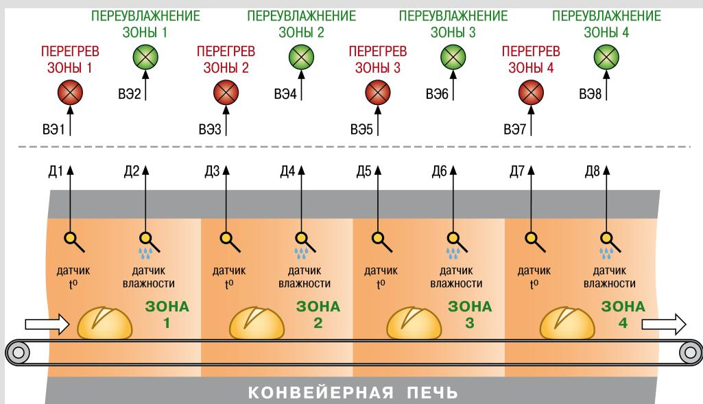
**Рисунок 7.5 – Использование восьмиканального регулятора TPM148 второй модификации в системе сигнализации автоматизированного технологического процесса выпекания хлебобулочных изделий**
