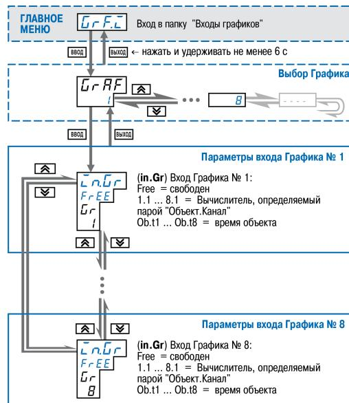
Рисунок 8.30 – Схема задания параметров входов графика
