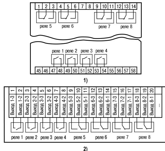
Рисунок 5.13 – Схема подключения электромагнитных реле прибора: 1) в корпусе Щ4, 2) в корпусе Щ7
