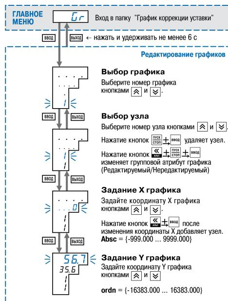
Рисунок 8.31 – Задание и редактирование графика коррекции уставки
