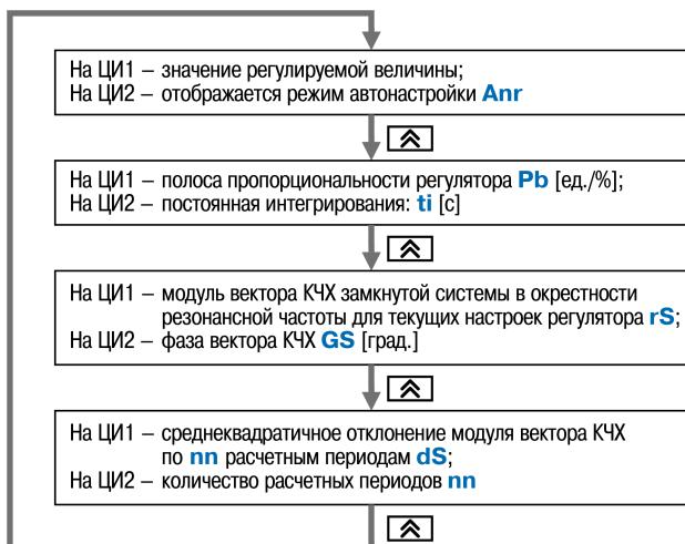
**Рисунок 10.20 – Схема переключения индикации в режиме Автонастройки**
