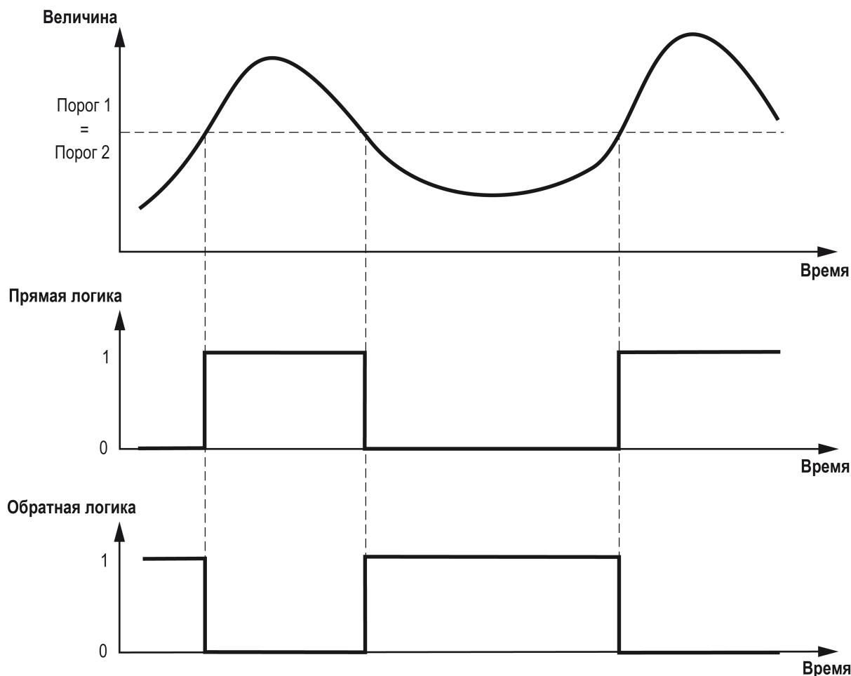
**Рисунок 10.54 – Работа Инспектора по прямой и обратной логикам**
