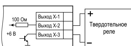
Рисунок 5.19 – Схема подключения нагрузки к ВУ типа Т
