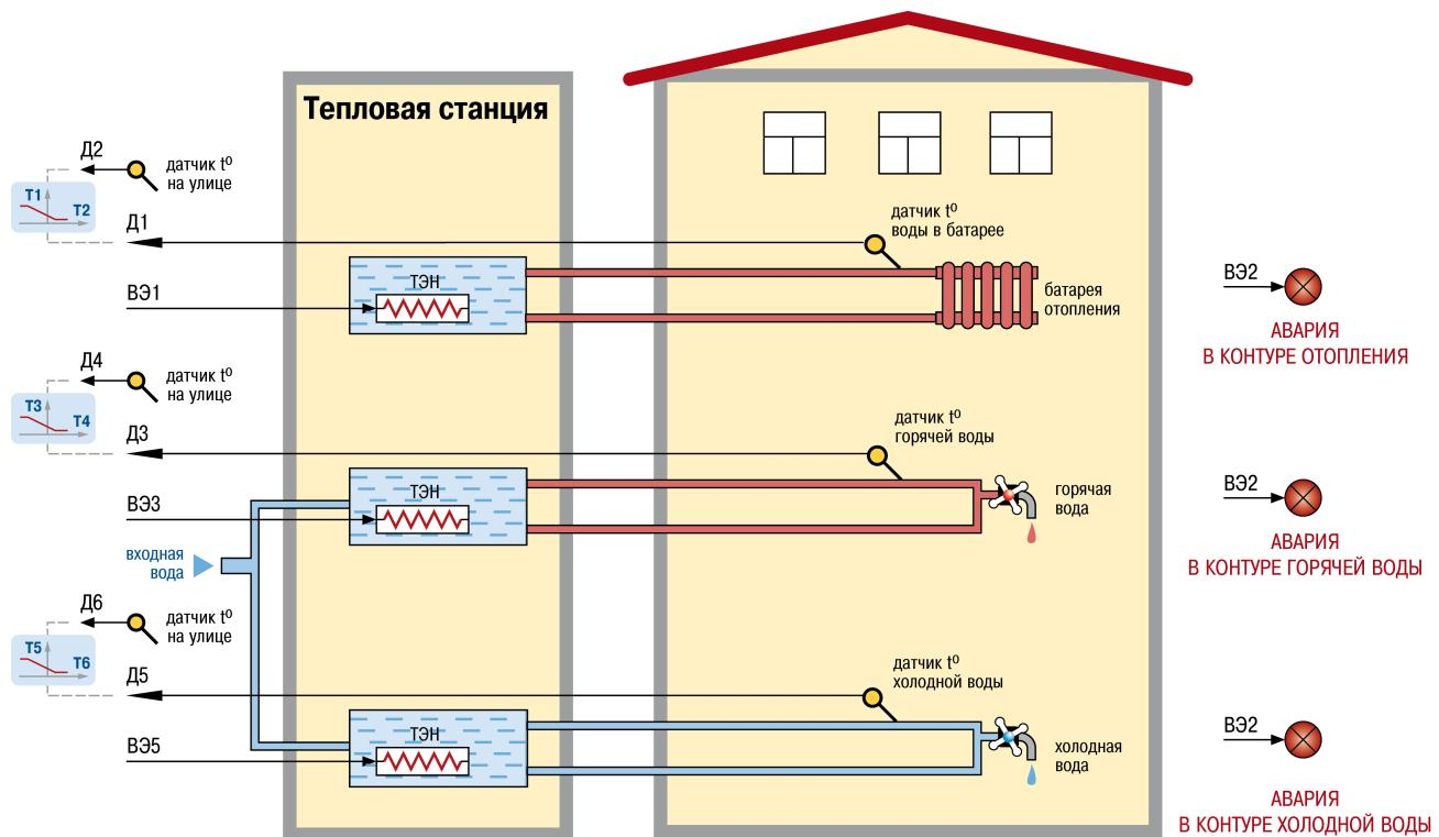
**Рисунок 7.12 – Использование восьмиканального регулятора TPM148 пятой модификации в системе теплоснабжения здания**
