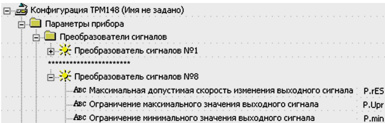
Рисунок 10.32 – Конфигуратор. Задание диапазона выходного сигнала
