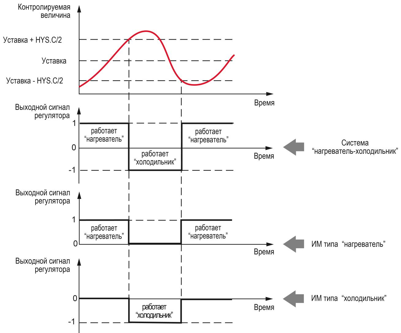
**Рисунок 10.22 – Принцип работы Двухпозиционного регулятора**
