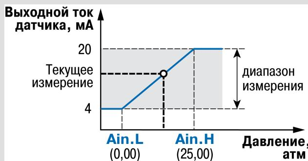
Рисунок 10.9 – Пример задания диапазона измерения активного датчика
