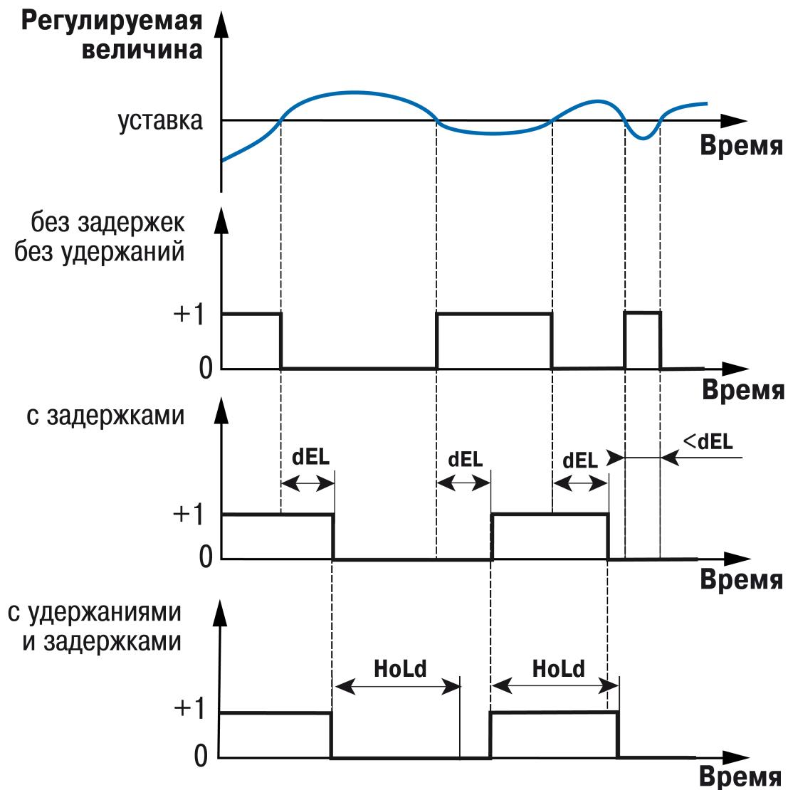
Рисунок 10.29 – Работа регулятора с заданными задержками и удержаниями
