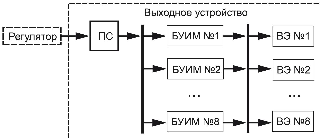
Рисунок 10.31 – Структурная схема Выходного устройства прибора
