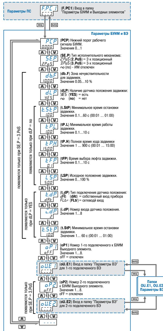
Рисунок 8.23 – Схема задания параметров БУИМ и Выходных элементов
