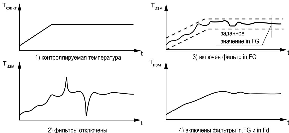
Рисунок 10.1 – Временные диаграммы работы цифровых фильтров
