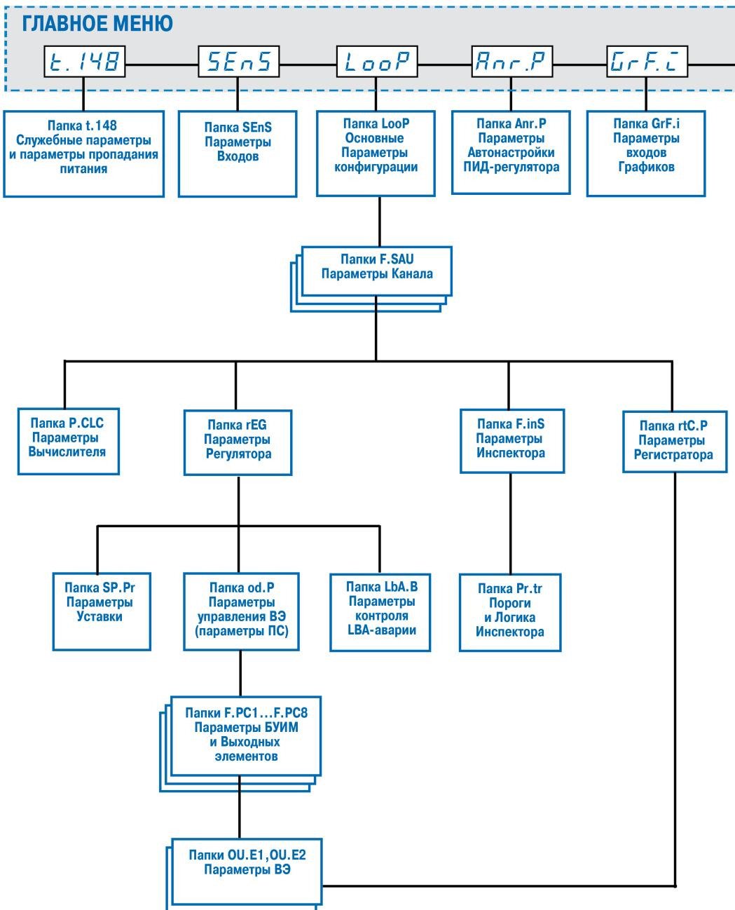
Рисунок 8.13 – Общая схема задания параметров прибора
