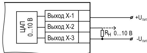
Рисунок 5.22 – Схема подключения нагрузки к ВУ типа У
