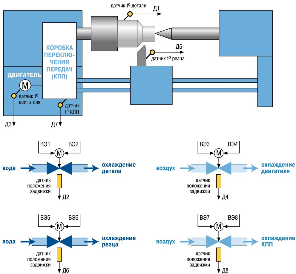
**Рисунок 7.7 – Использование восьмиканального регулятора TPM148 третьей модификации в технологической системе управления охлаждением станка для точной обработки деталей**
