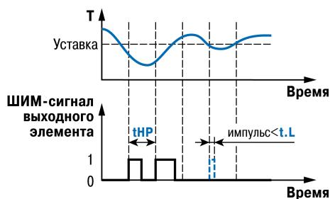
**Рисунок 10.44 – Точность регулирования при разной частоте управляющих импульсов**
