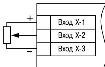
**Рисунок 5.11 – Схема подключения резистивного датчика положения задвижки**
