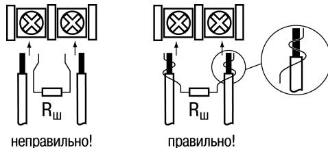
**Рисунок 5.9 – Подключение шунтирующего резистора**
