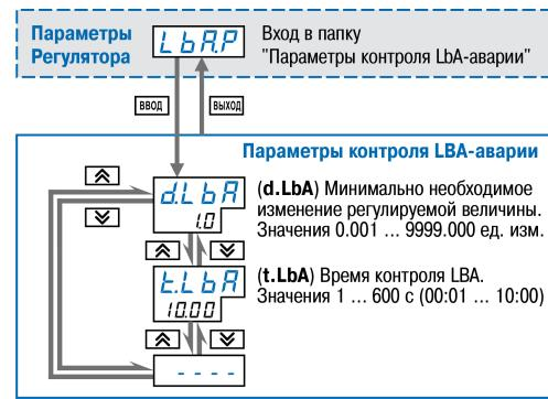
Рисунок 8.25 – Схема задания параметров контроля LbA-аварии
