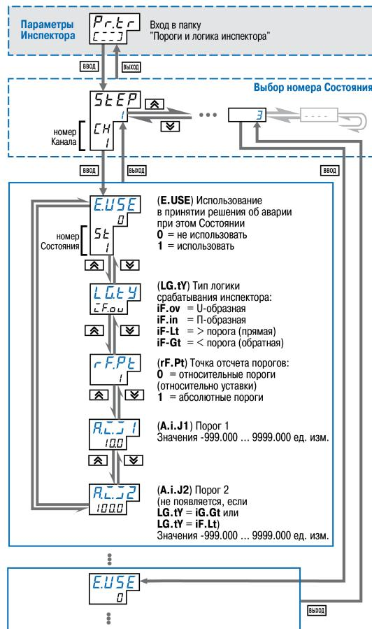
Рисунок 8.27 – Схема задания порогов и логики Инспектора
