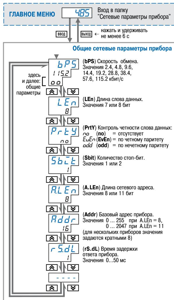
Рисунок 8.32 – Схема задания сетевых параметров прибора
