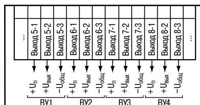
Рисунок 5.23 – Схема подключения выходных устройств прибора TPM 13x-U
