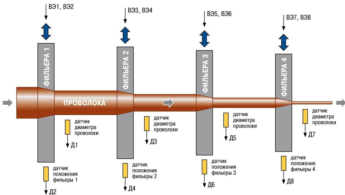
Рисунок 7.8 – Использование восьмиканального регулятора ТРМ148 третьей модификации в управляемой автоматизированной системе из четырех фильтров для получения проволоки
