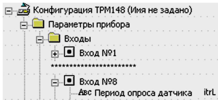
**Рисунок 10.7 – Конфигуратор. Задание периода опроса датчика**
