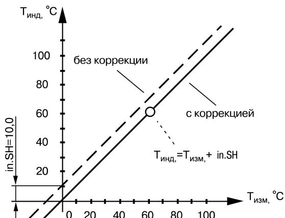
Рисунок 10.2 – Коррекция «сдвиг характеристики»
