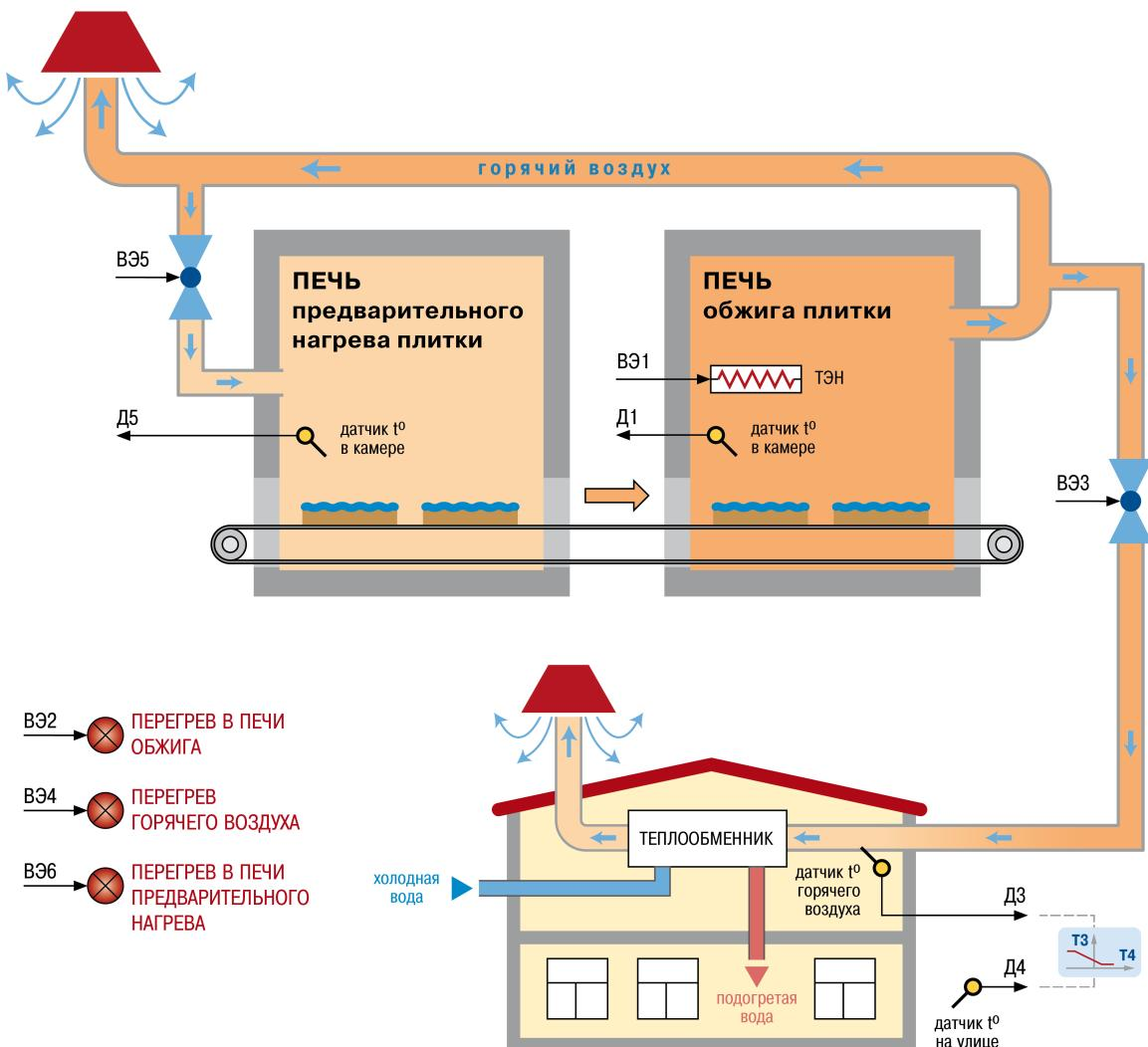
Рисунок 7.13 – Использование восьмиканального регулятора TPM148 пятой модификации в системе термообработки (обжига) керамической плитки
