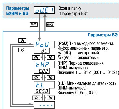
Рисунок 8.24 – Схема задания параметров Выходных элементов
