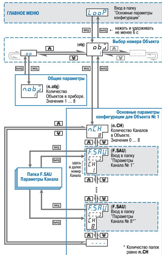
Рисунок 8.17 – Схема задания основных параметров конфигурации
