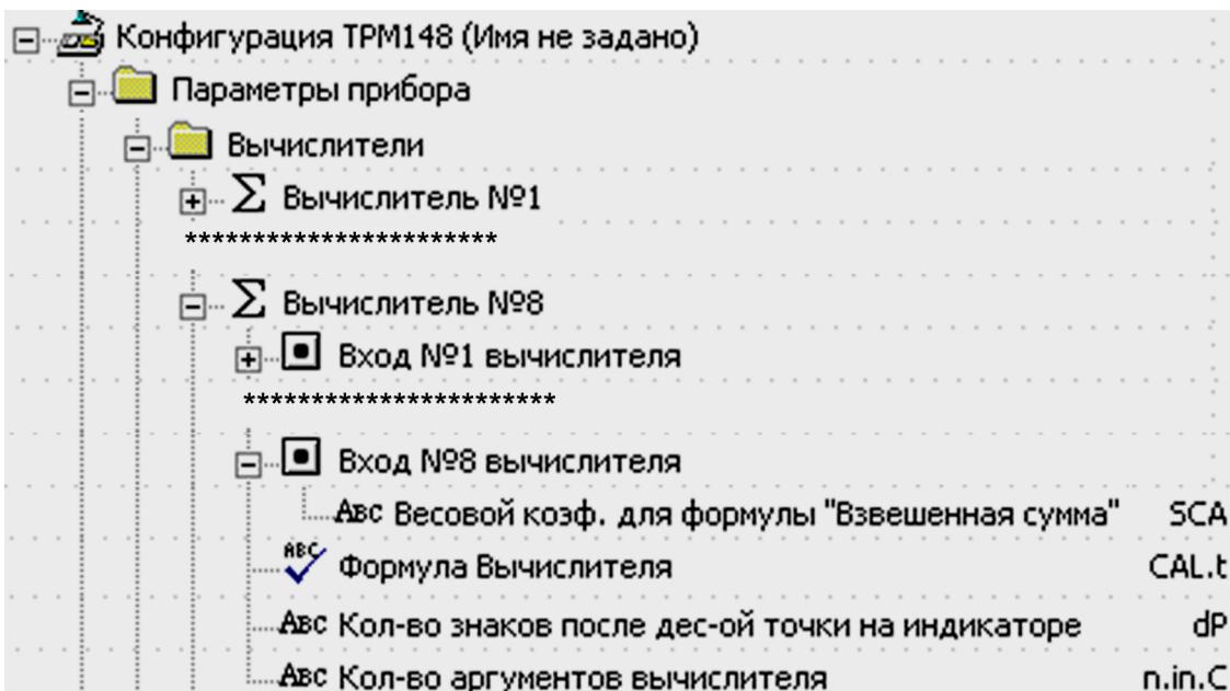
Рисунок 10.12 – Конфигуратор. Настройка связей входов прибора с Вычислителями
