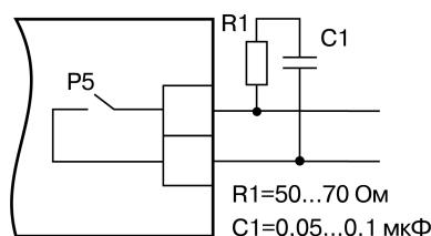
**Рисунок 5.12 – Схема подключения нагрузки к ВУ типа Р**
