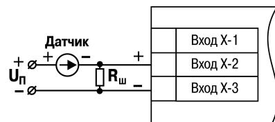
**Рисунок 5.10 – Схема подключения датчика положения задвижки с токовым выходом  $0$  ( $4...20\text{ mA}$ )  $R_{sh} = 100,000 \pm 0,025\text{ Ом}$**
