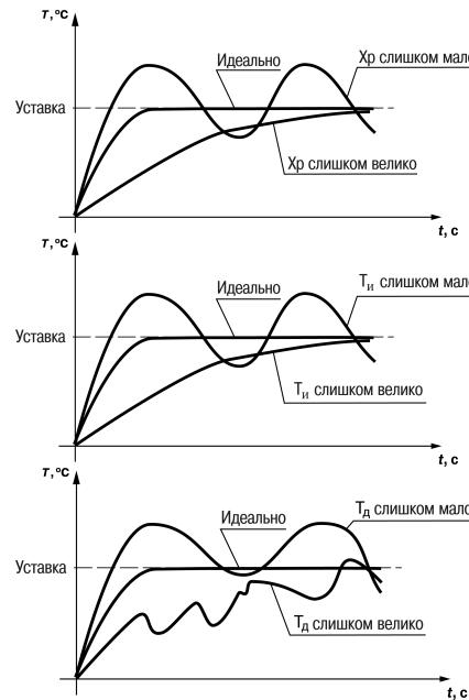
При оптимальной подстройке регулятора график регулируемой величины должен иметь минимальное значение показателя ошибки регулирования ( $A_1$ ) при достаточно степени затухания  $\phi = 1 - A_3/A_1 (0,8\dots0,9)$ .
