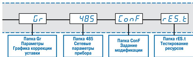
Рисунок 8.14 – Общая схема задания параметров прибора (продолжение)
