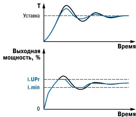
**Рисунок 10.17 – ПИД-регулирование**
