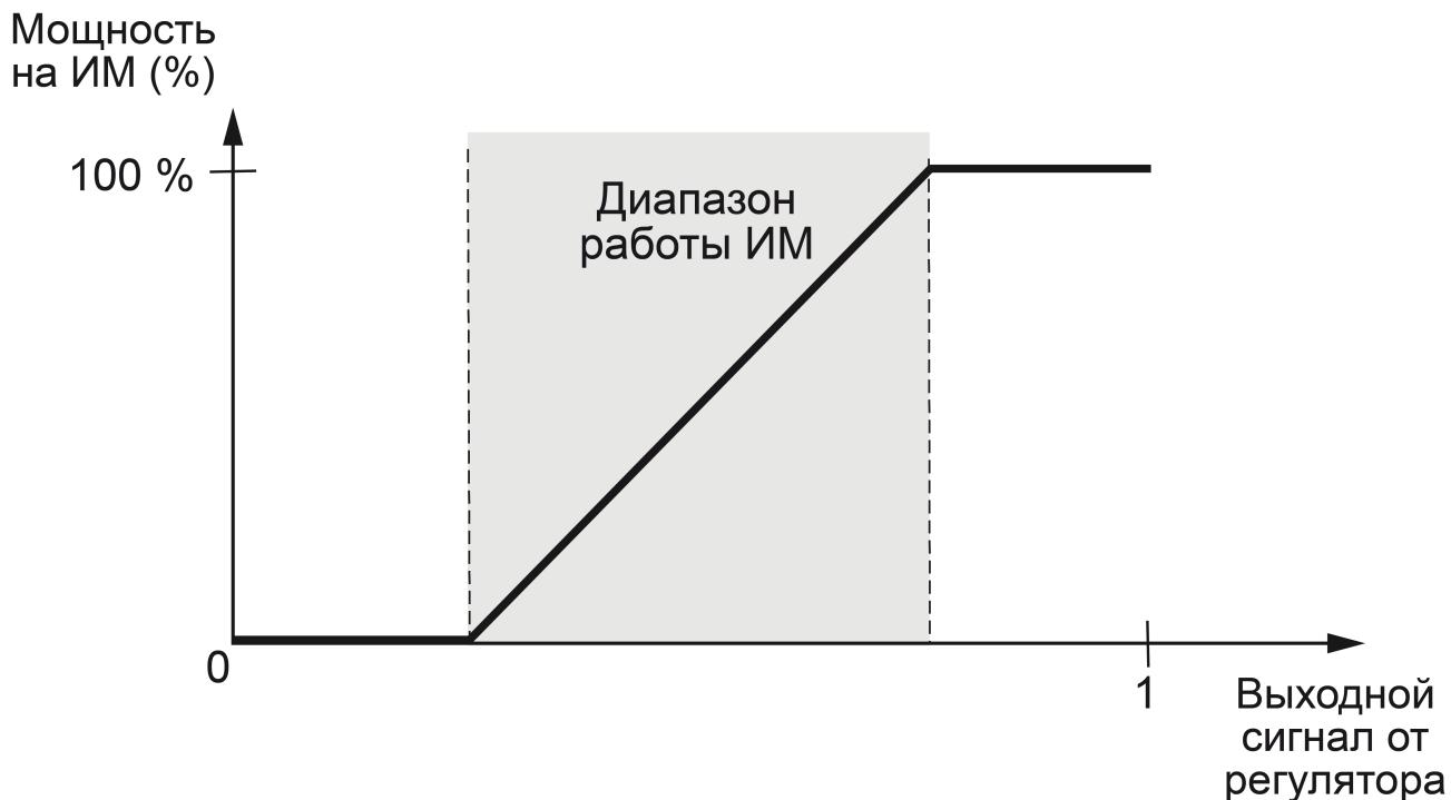
**Рисунок 10.39 – Работа ИМ (тип «Нагреватель») в заданном диапазоне**
