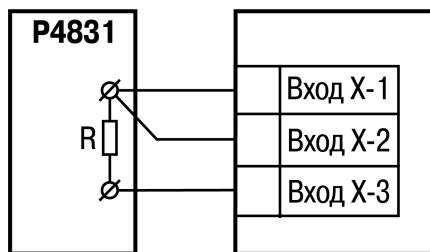
**Рисунок 11.1 – Подключение прибора к ТСМ и ТСП**
