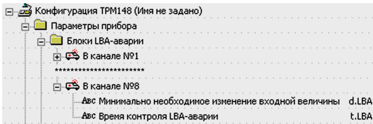
Рисунок 10.30 – Конфигуратор. Контроль LBA
