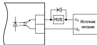
Рисунок 5.14 – Схема подключения нагрузки к ВУ типа К
