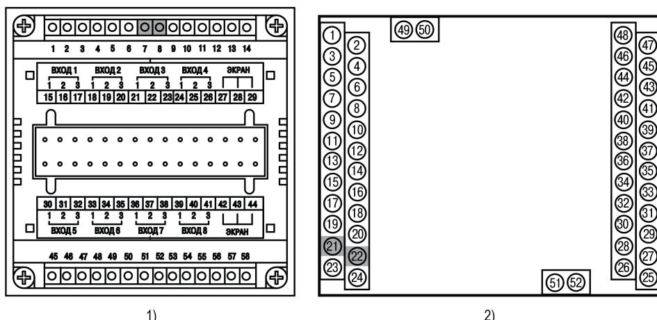
**Рисунок 5.2 – Клеммники: TPM148-X (1) и Клеммник TPM148-X.Щ7 (2)**
