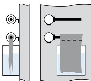
**Рисунок Б.2 – Крепление датчиков температуры параллельно стенке камеры**
