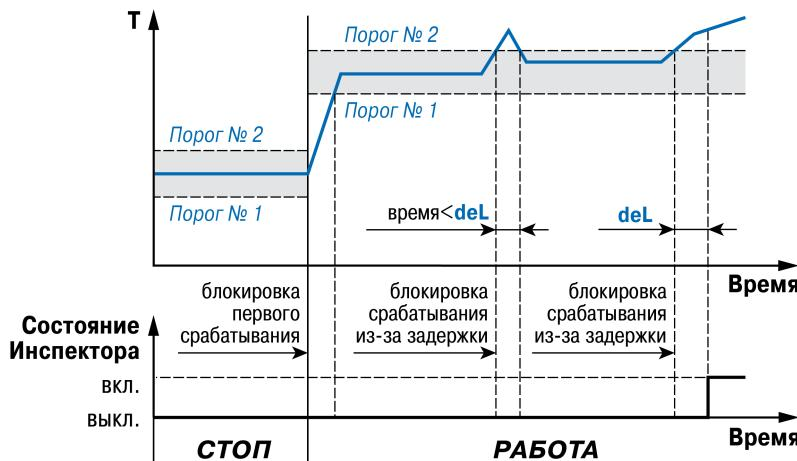
Рисунок 10.56 – Пример логики работы и блокировок срабатывания Инспектора
