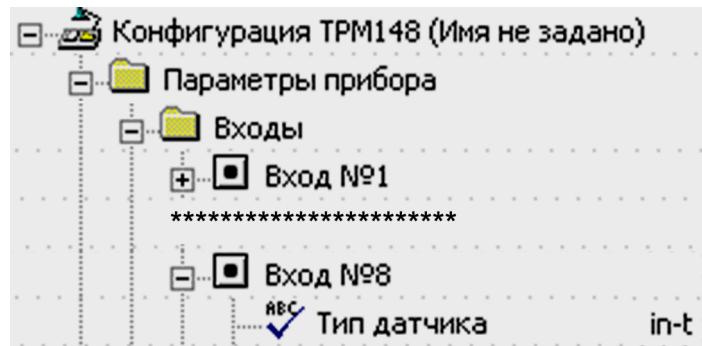
**Рисунок 10.6 – Конфигуратор. Выбор типа датчика**
