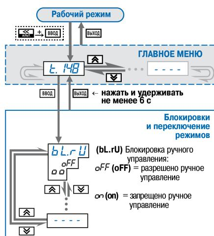
Рисунок 6.5 – Схема задания блокировок и переключения режимов
