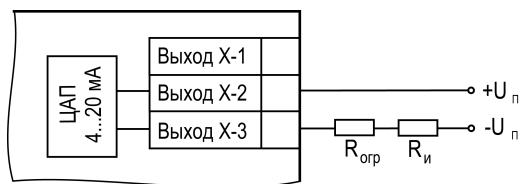
Рисунок 5.21 – Схема подключения нагрузки к ВУ типа И
