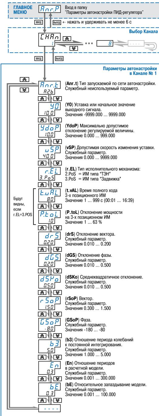
Рисунок 8.29 – Схема задания параметров Автонастройки ПИД-регулятора
