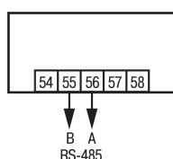
Рисунок 5.24 – Схема подключения для интерфейса RS-485
