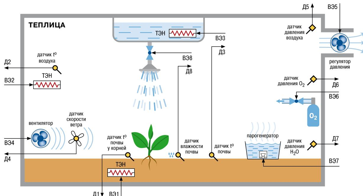
**Рисунок 7.2 – Использование восьмиканального регулятора TPM148 1-ой модификации для поддержания в заданных диапазонах величин параметров жизнедеятельности теплицы для испытания выживаемости растений**
