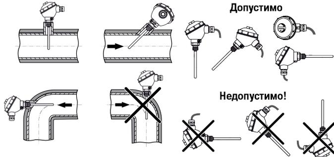
Рисунок 1 – Положения датчика при монтаже
