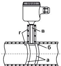
Рисунок 2 – Монтаж датчика ДТС325M-RS: а) хомут; б) пластина-теплообменник; в) арматура датчика; г) теплоизоляционный материал для трубопровода
