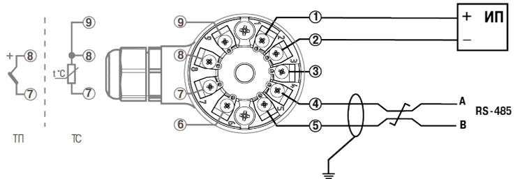
Рисунок 7 – Схема с подключением экрана к заземлению
