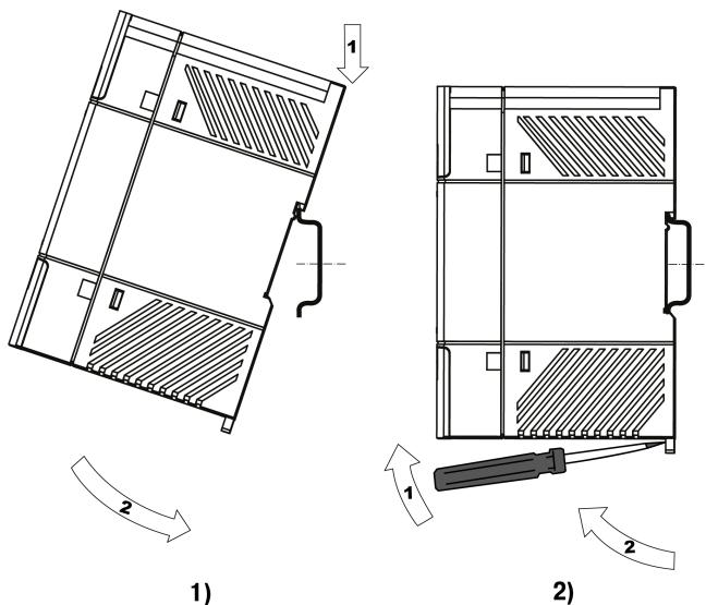
**Рисунок 4.2 – Монтаж (1) и демонтаж (2) прибора**
