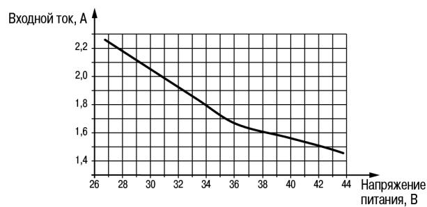
Рисунок 6.2 – График зависимости входного тока (РСП ЖД-станций) от напряжения питания
