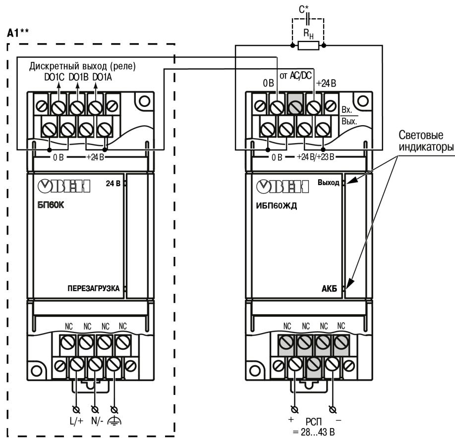
**Рисунок 5.1 – Схема подключения**
