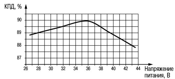
Рисунок 6.3 – График зависимости КПД от напряжения питания (от РСП ЖД-станций)
