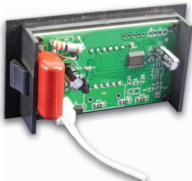
*Рис. 2 – Вид сзади с подключенным входным сигналом и питанием*
