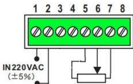
Напряжение +5В генерируется самим модулем без внешнего источника питания.
