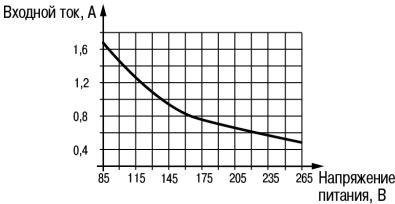
Рисунок 9 – График зависимости входного тока от напряжения питания
