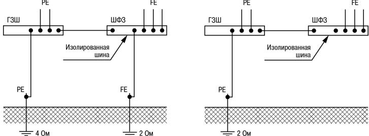
1) Рисунок 7 – Схемы функционального заземления
