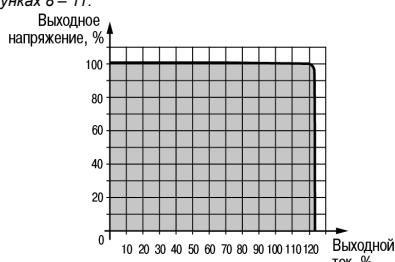
Рисунок 8 – График зависимости выходного напряжения от номинального выходного тока
