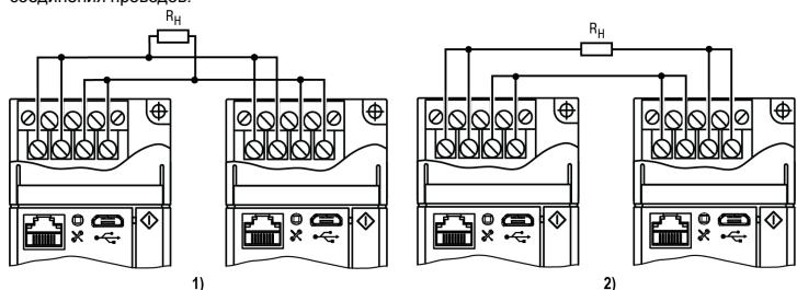
Рисунок 6 – Схема параллельного (1) и последовательного (2) подключения нескольких приборов
