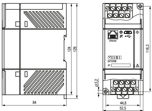
Рисунок 3 – Габаритные и установочные размеры прибора
