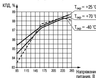
Рисунок 11 – График зависимости КПД от напряжения питания и температуры окружающей среды
