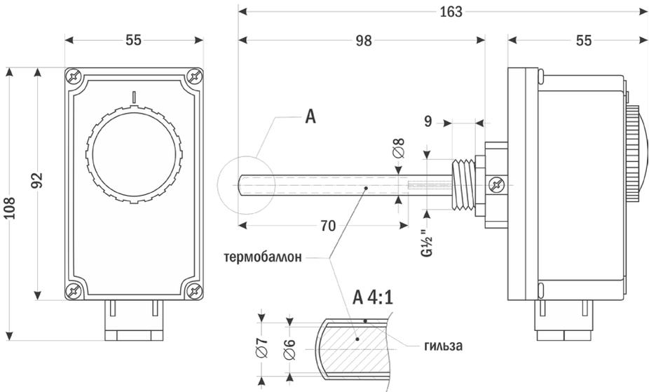
Рис. 2 – Размеры прибора
