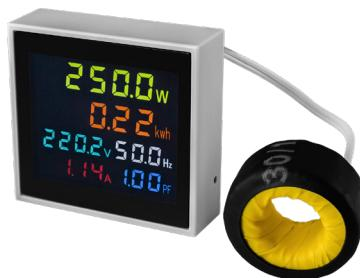
Индикатор-мультиметр однофазный Omix T55-M6-1 предназначен для измерения и индикации напряжения, силы тока, частоты, активной мощности, коэффициента мощности и активной энергии в однофазных сетях переменного тока.
