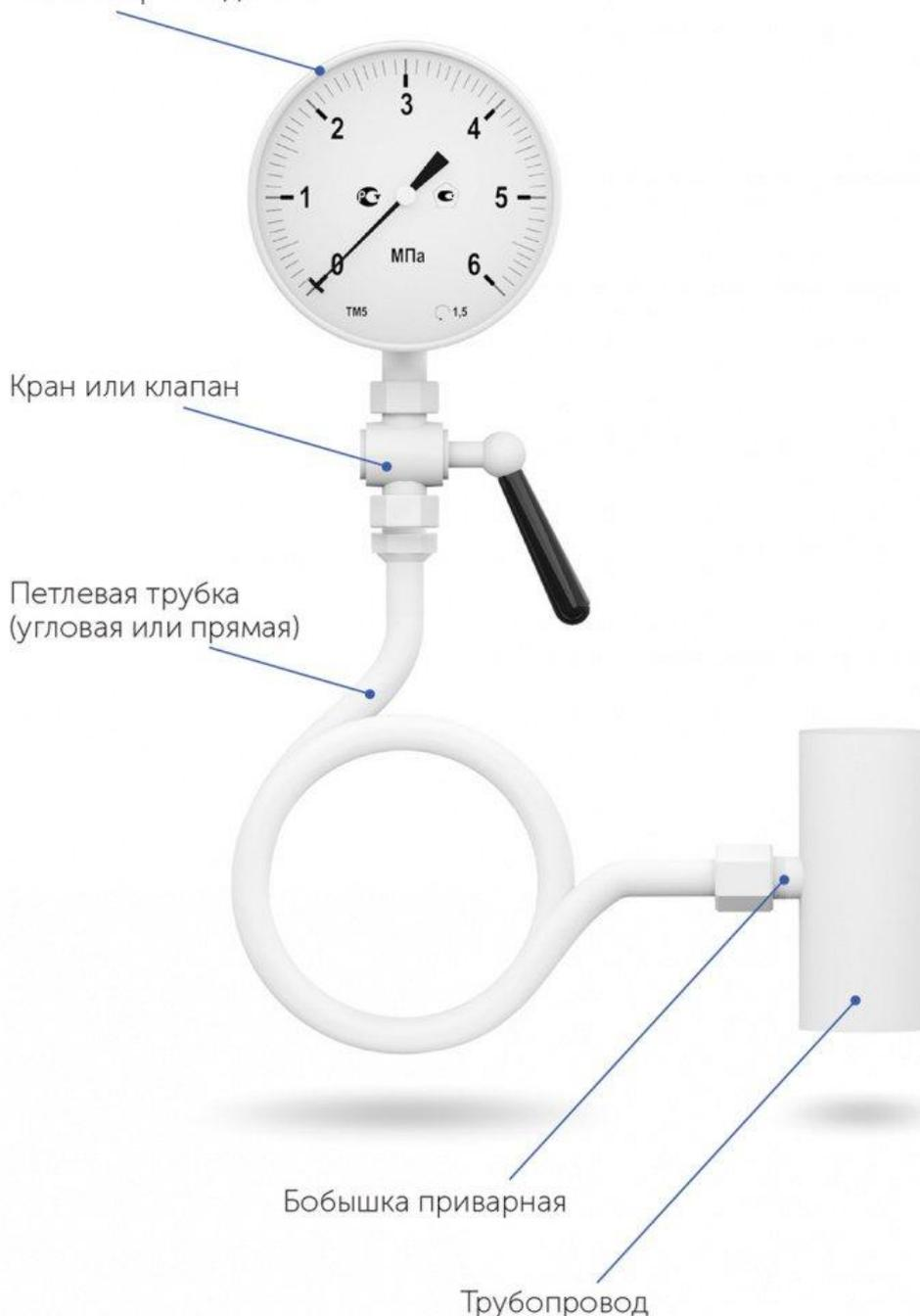
Типовой узел отбора для подключения манометра состоит из приварной бобышки с площадкой под уплотнительную прокладку, петлевой трубки, трехходового крана или игольчатого клапана. В качестве уплотнения в резьбовых соединениях между приварной бобышкой, краном и манометром рекомендуется применять паронитовую, фторопластовую или медную прокладку.
