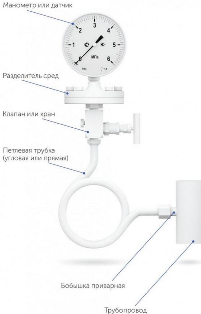
Типовой узел отбора для подключения манометра состоит из приварной бобышки с площадкой под уплотнительную прокладку, петлевой трубы, трехходового крана или игольчатого клапана. В качестве уплотнения в резьбовых соединениях между приварной бобышкой, краном и манометром рекомендуется применять паронитовую, фторопластовую или медную прокладку.
