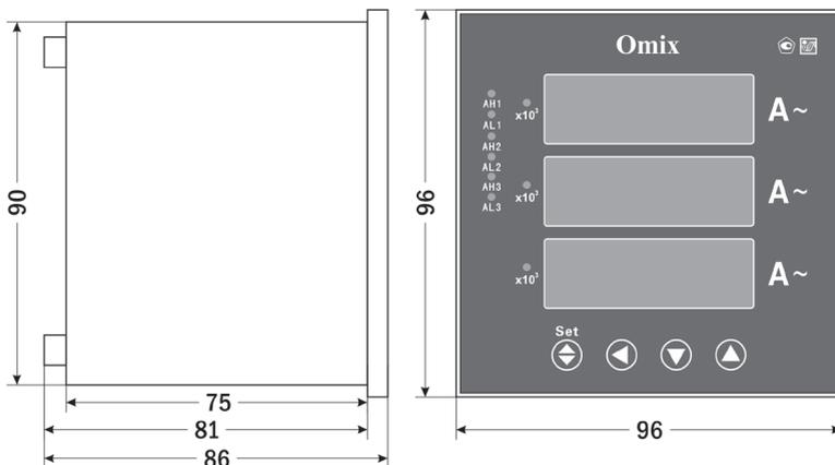
Рис. 3 – Размеры прибора
