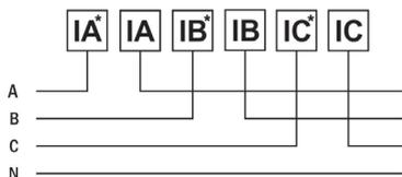
Рис. 5 – Подключение напрямую
