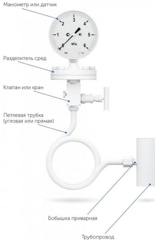
Типовой узел отбора для подключения вакуумметра состоит из приварной бобышки с площадкой под уплотнительную прокладку, петлевой трубки, трехходового крана или игольчатого клапана. В качестве уплотнения в резьбовых соединениях между приварной бобышкой, краном и вакуумметром рекомендуется применять паронитовую, фторопластовую или медную прокладку.
