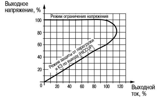
Рисунок 2 – График зависимости выходного напряжения от выходного тока
