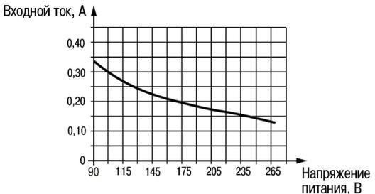
Рисунок 3 – График зависимости входного тока от напряжения питания
