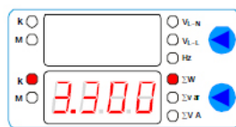
Рис. 18 – Пример работы прибора. Режим отображения суммарной активной мощности
