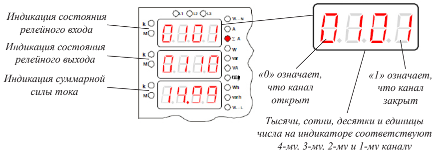
Рис. 15 – Пример работы прибора. Режим отображения суммарной силы тока. Суммарная сила тока равна 14,99 А
