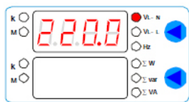
Рис. 17 – Пример работы прибора. Режим отображения среднего фазного напряжения
