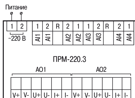
Рисунок 5.3 – Назначение контактов клеммника прибора с питанием 230 В
