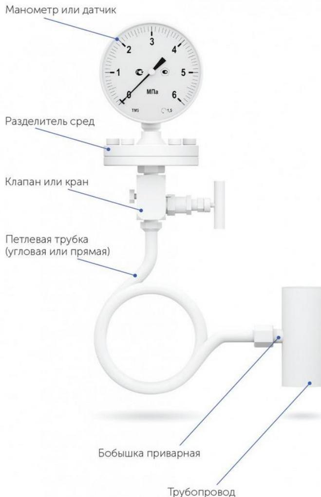
Типовой узел отбора для подключения мановакуумметра состоит из приварной бобышки с площадкой под уплотнительную прокладку, петлевой трубки, трехходового крана или игольчатого клапана. В качестве уплотнения в резьбовых соединениях между приварной бобышкой, краном и мановакуумметром рекомендуется применять паронитовую, фторопластовую или медную прокладку.
