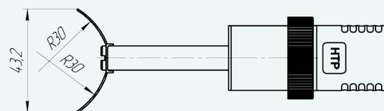
2 хомута в комплекте. Усилено место крепления контактной пластины к арматуре датчика
