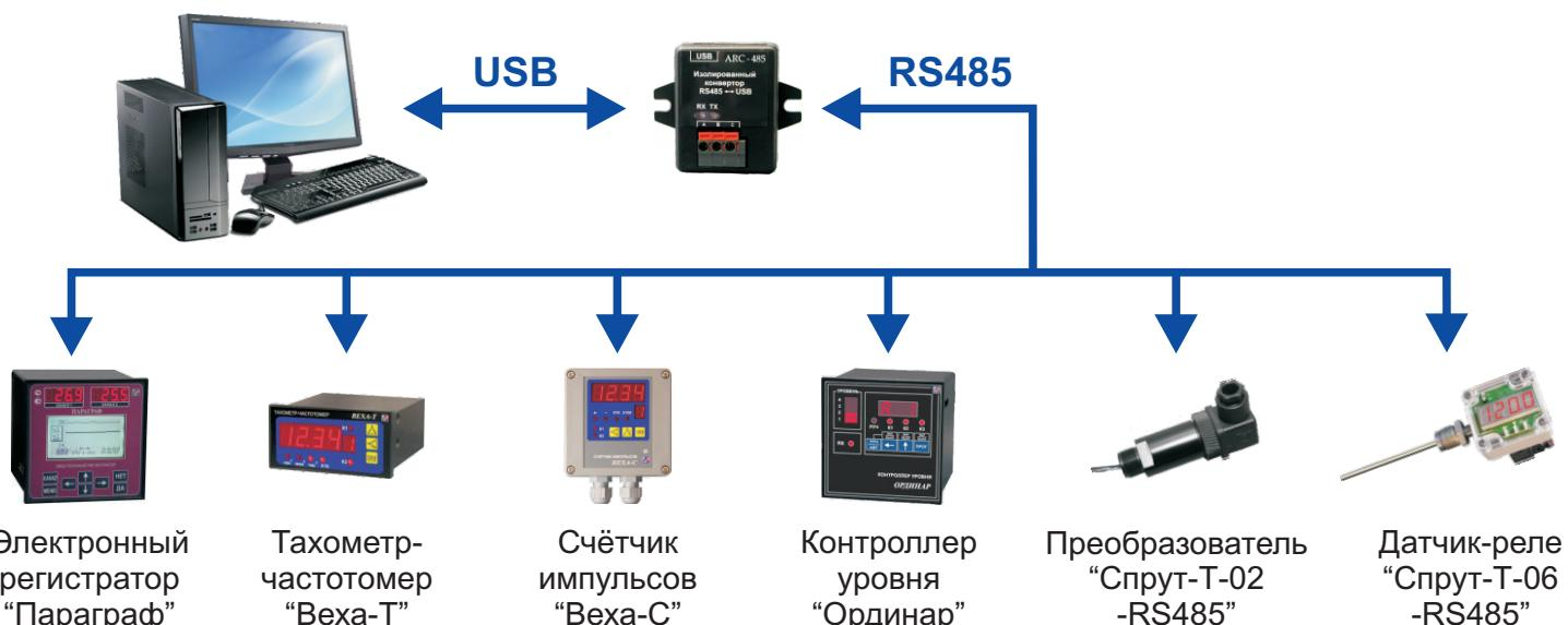
Определяется операционной системой как последовательный порт (com-port, RS-232).
