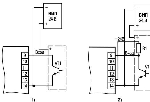
Рисунок 5.4 – Подключение датчиков с *n-p-n*-выходом: 1) пассивных; 2) активных
