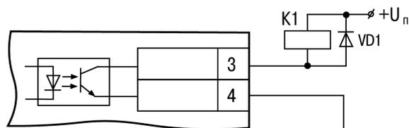
Рисунок 5.8 – Схема подключения нагрузки к ВУ типа К
