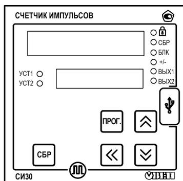
Рисунок 6.2 – Лицевая панель прибора для корпусов настенного Н и щитового Ц1 креплений
