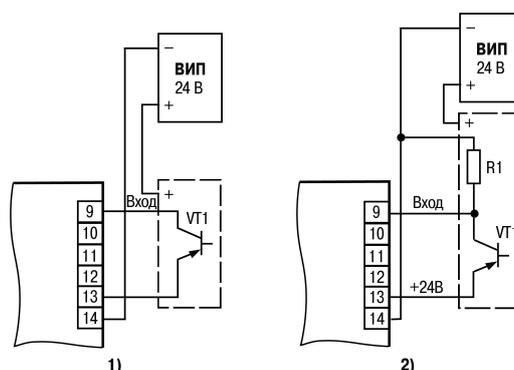
**Рисунок 5.5 – Подключение датчиков с р-п-р-выходом: 1) пассивных; 2) активных**
