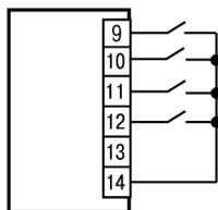
Рисунок 5.2 – Подключение коммутационных устройств типа «сухой контакт»
