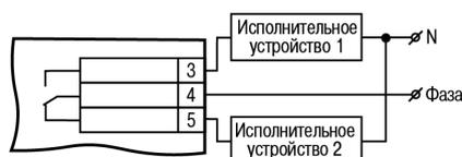
**Рисунок 5.7 – Схема подключения нагрузки к ВУ типа Р**
