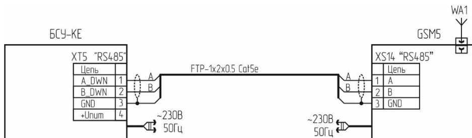
Рисунок 7 – Схема подключения для программирования адреса
