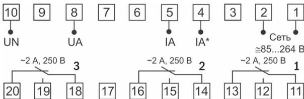
Рис. 4 – Клеммы подключения
