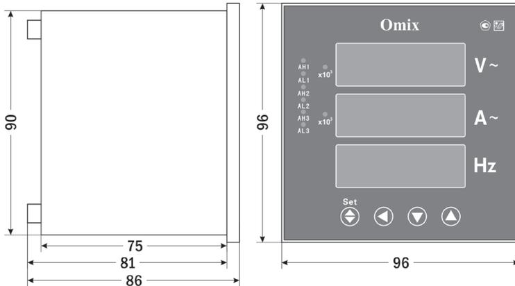
Рис. 3 – Размеры прибора
