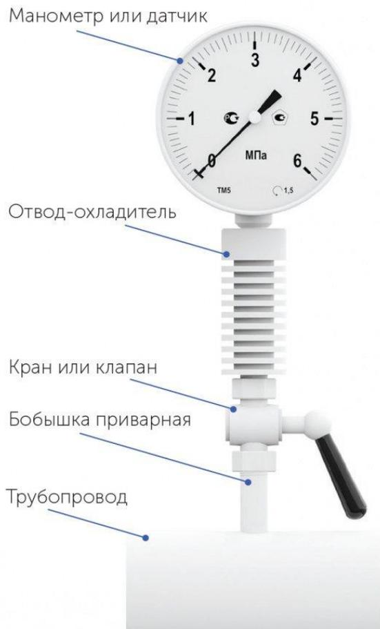
Для защиты мановакуумметра от воздействия пульсаций измеряемой среды рекомендуется использовать демпферное устройство с регулировочной иглой.
