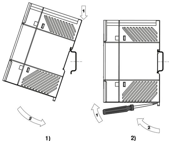
Рисунок 4 – Монтаж (1) и демонтаж (2) прибора
