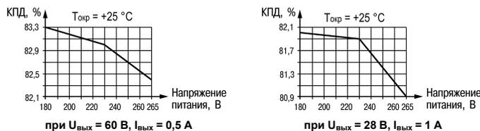
Рисунок 9 – Графики зависимости КПД от напряжения питания
