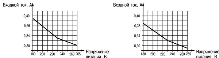
Рисунок 8 – Графики зависимости входного тока от напряжения питания
