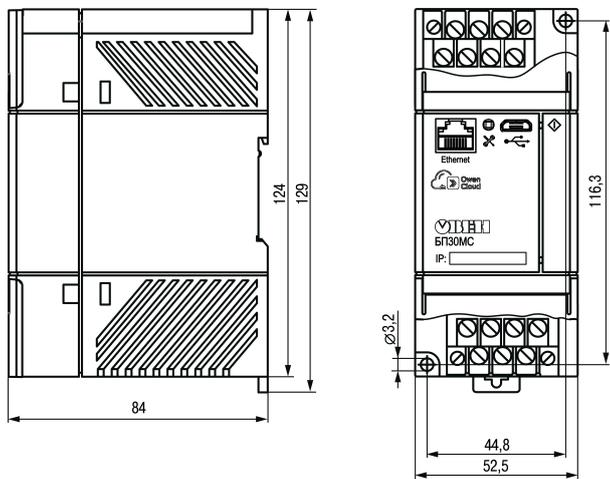
Рисунок 3 – Габаритные и установочные размеры прибора
