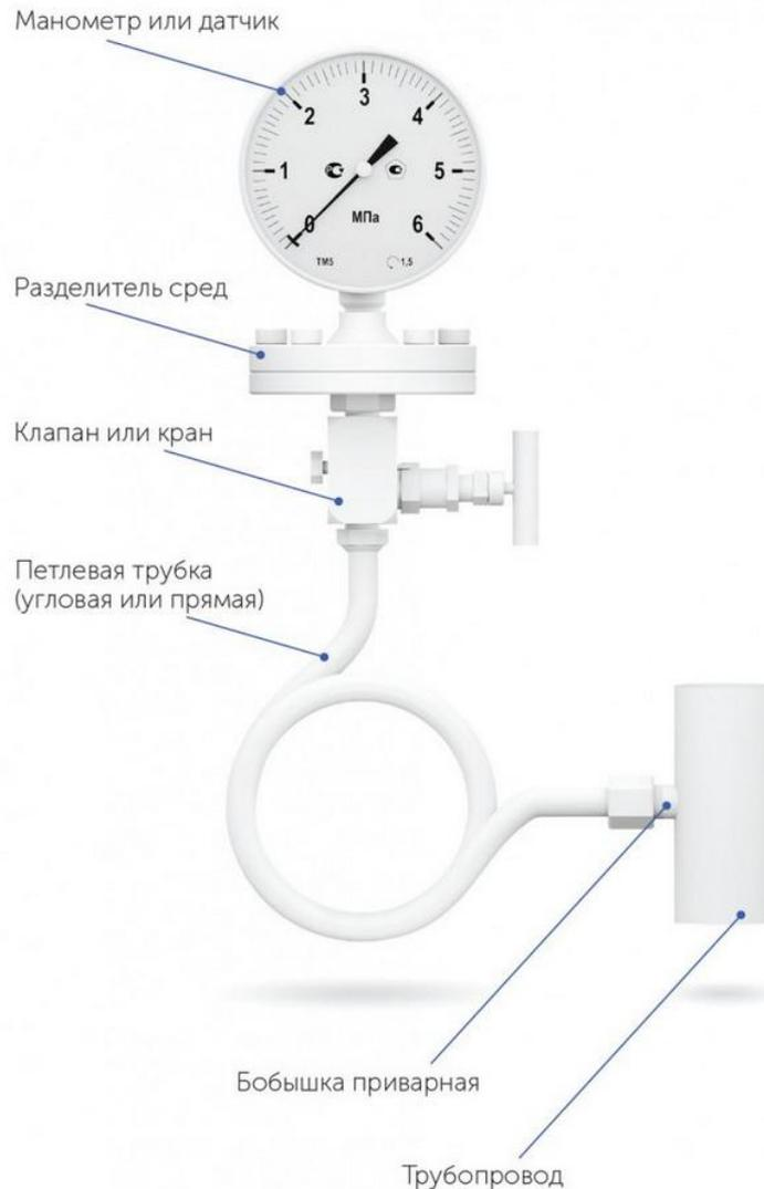
Типовой узел отбора для подключения вакуумметра МТИ состоит из приварной бобышки с площадкой под уплотнительную прокладку, петлевой трубки, трехходового крана или игольчатого клапана. В качестве уплотнения в резьбовых соединениях между приварной бобышкой, краном и вакуумметром рекомендуется применять паронитовую, фторопластовую или медную прокладку.
