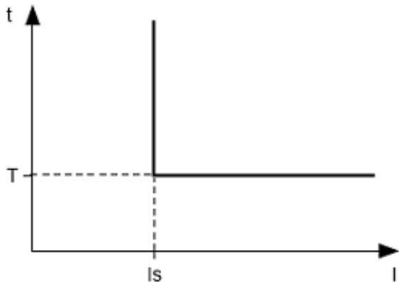
Рисунок 1.2 - Принцип защиты с независимой выдержкой времени
