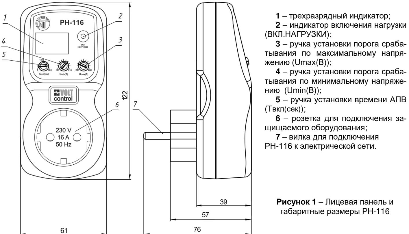
**Рисунок 1 – Лицевая панель и габаритные размеры РН-116**
