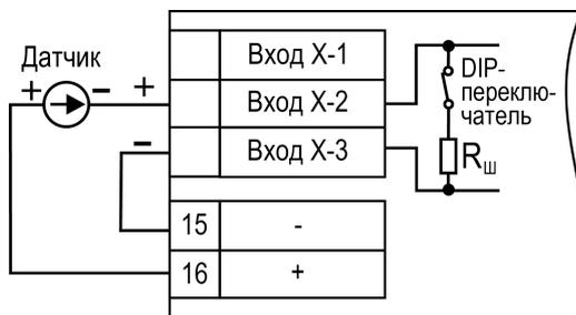
**Рисунок 5.9 – Подключение токового датчика с питанием от ИП24**
