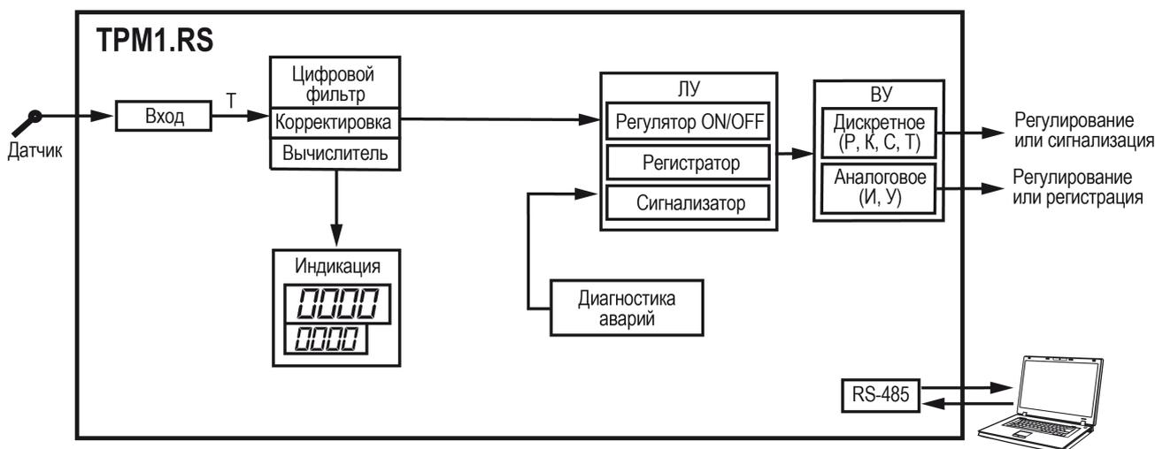
Рисунок 6.1 – Функциональная схема
