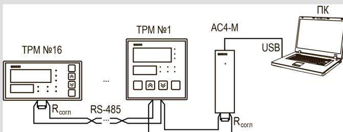
**Рисунок 5.8 – Подключение приборов по сети RS-485**
