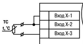
**Рисунок 5.11 – Двухпроводная схема подключения ТС**
