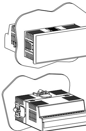
Рисунок 4.4 – Монтаж прибора щитового крепления Щ2
