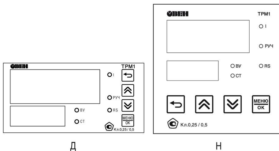
Рисунок 6.3 – Лицевая панель корпусов Д и Н
