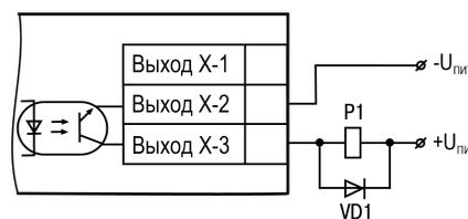
Рисунок 5.18 – Схема подключения нагрузки к ВУ типа «К»
