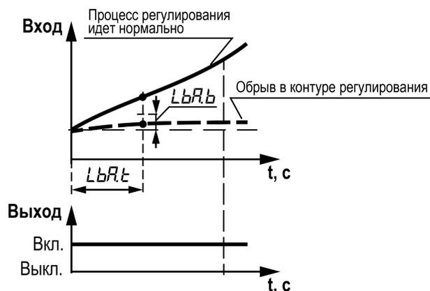
Рисунок 7.4 – Диагностика обрыва в контуре регулирования
