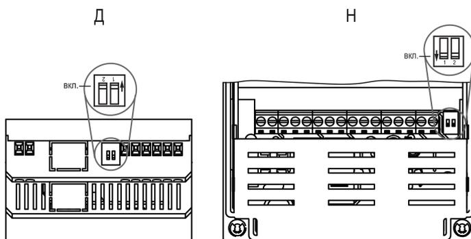
**Рисунок 5.16 – Расположение DIP-переключателей для корпусов Д и Н**
