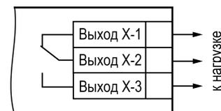
Рисунок 5.17 – Схема подключения нагрузки к ВУ типа «Р»
