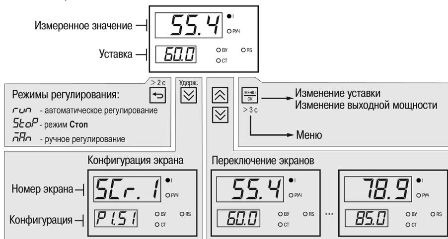
Рисунок 6.5 – Схема переходов с главного экрана
