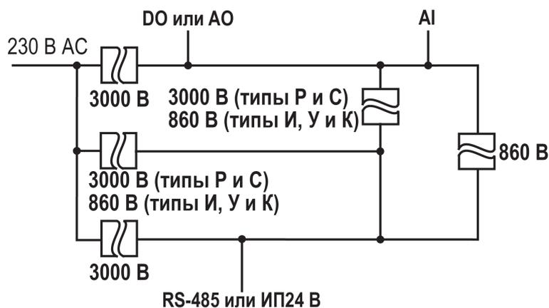
Рисунок 5.3 – Схема гальванической развязки (выходы кроме типа «Т»)
