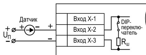
Рисунок 5.14 – Схема подключения пассивного датчика с токовым выходом 0...5 мА или 0 (4)...20 мА
