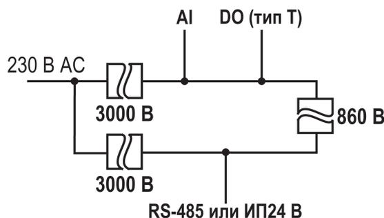
**Рисунок 5.2 – Схема гальванической развязки (выход типа «Т»)**
