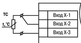
**Рисунок 5.10 – Трехпроводная схема подключения ТС****5.7.3 Подключение ТС по двухпроводной схеме**
