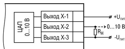
**Рисунок 5.24 – Схема подключения нагрузки к ВУ типа «У»**
