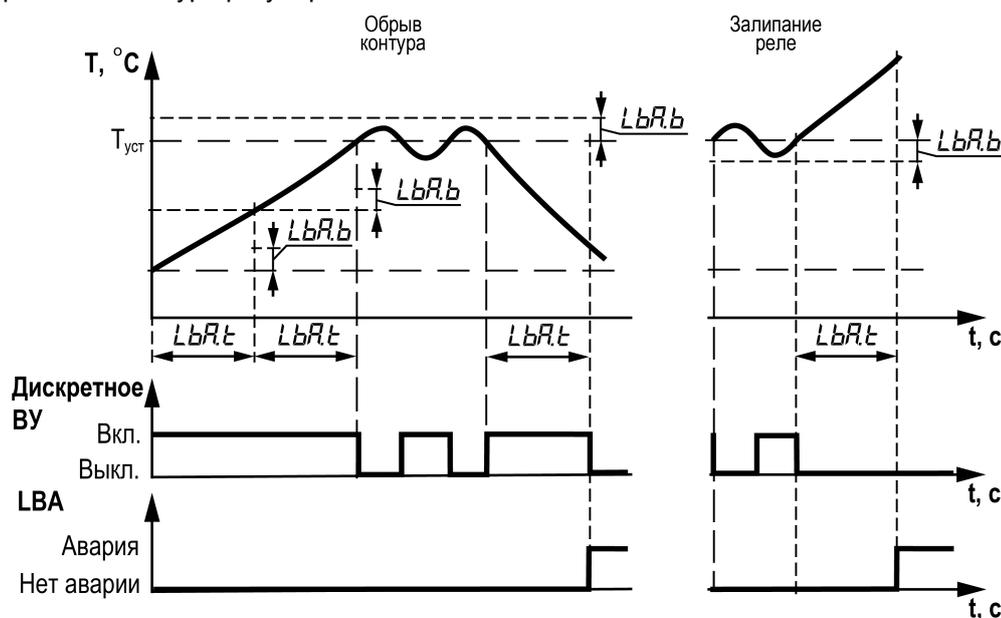
Рисунок 7.5 – Принцип работы диагностики обрыва в контуре регулирования
