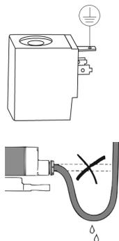
**Внимание!** Вода не должна проникать в клеммную коробку. Кабель необходимо монтировать с образованием петли для стекания капель жидкости.
