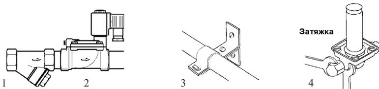
1. Перед монтажом клапана трубопроводы должны быть прочищены, т.к. попадание в клапан инородных частиц может привести к выходу его из строя. Перед входным отверстием соленоидного клапана необходимо установить фильтр-грязевик.
