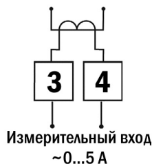
Рис. 3 – Схема подключения прибора.
