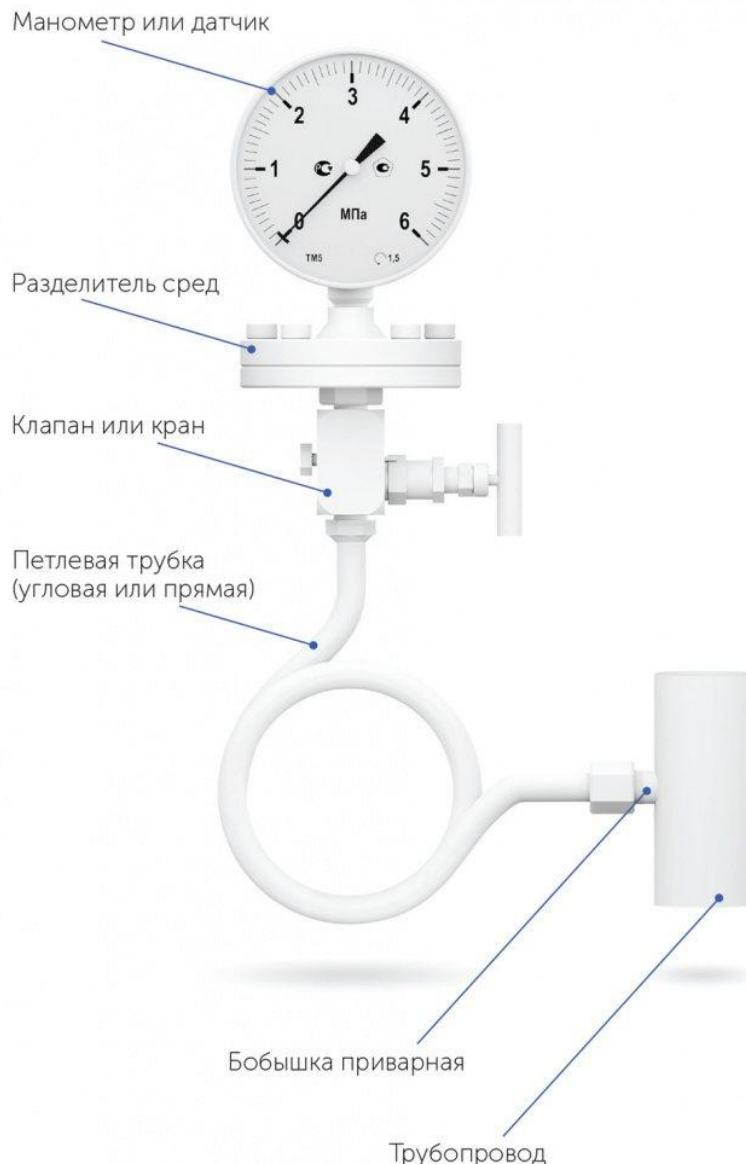
Типовой узел отбора для подключения манометра МТИ состоит из приварной бобышки с площадкой под уплотнительную прокладку, петлевой трубы, трехходового крана или игольчатого клапана. В качестве уплотнения в резьбовых соединениях между приварной бобышкой, краном и манометром рекомендуется применять паронитовую, фторопластовую или медную прокладку.
