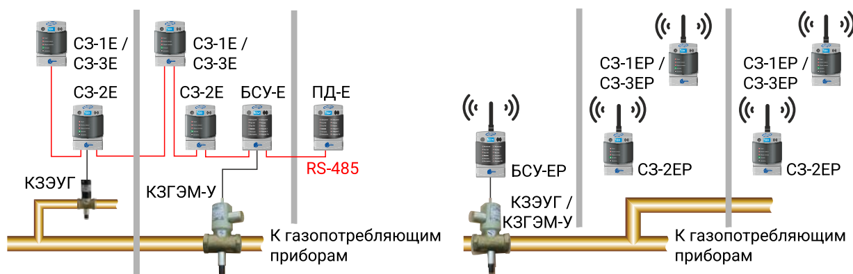
Принципиальная схема построения САКЗ-МК®-2Е: интерфейс RS485 (слева) и радиоканальное решение (справа)
