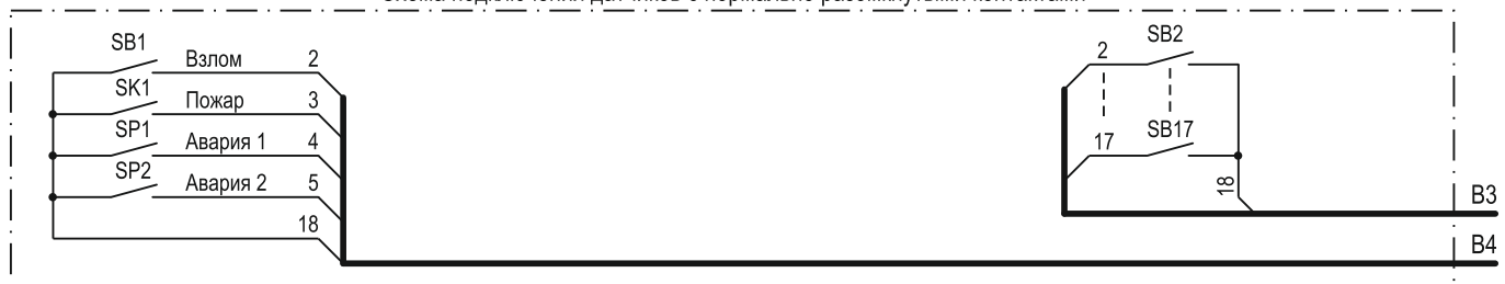
Схема подключения датчиков с нормально разомкнутыми контактами
